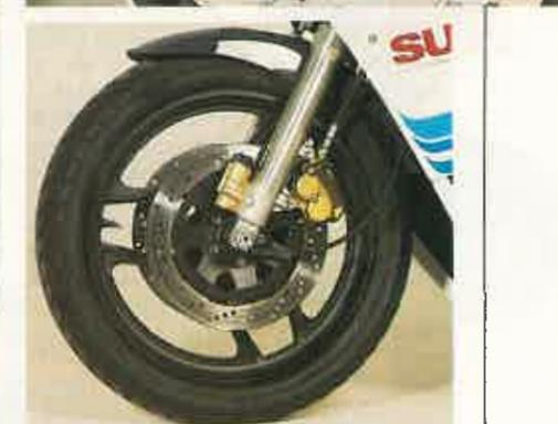
que el comportamiento de la moto se altere hasta límites preocupantes. Seguramente por esta razón Suzuki, que fue la primera marca en adoptar la llanta de 16 pulgadas delantera, ha equipado la GSX-R con una de 18 pulgadas, cosa que reduce la sensibilidad en la dirección.
