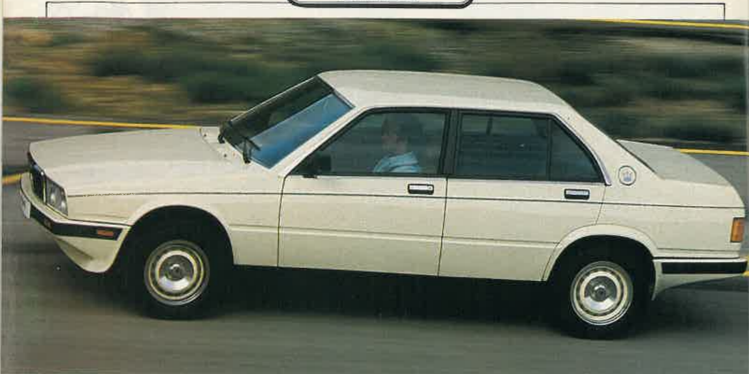
Impecable comportamiento del Maserati Biturbo, que alcanza 215 km/h. Los frenos están a la altura de esta velocidad máxima, pero la dirección es demasiado lenta
