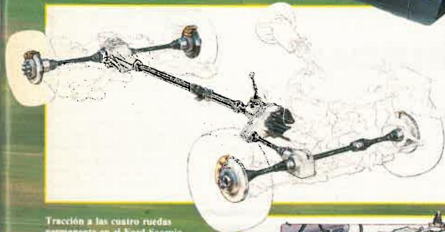
Tracción a las cuatro ruedas permanente en el Ford Scorpio. El motor es el V-6 de 2,8 con inyección, que desarrolla 150 caballos. En detalle, el conjunto de la transmisión, que lleva dos diferenciales de acoplamiento viscoso, uno central y otro en el eje trasero.
