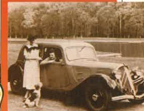
**1934** El Citroën 7 fue el primer modelo de tracción delantera puesto a punto por el constructor francés. Este modelo se construyó con leves variaciones hasta 1957. Tracción delantera y suspensión por barras de torsión fueron las notas revolucionarias de un coche adelantado a su tiempo. En nuestro país el más difundido fue el «11 Ligero».
