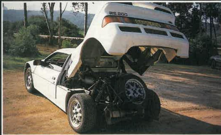
El motor cuatro cilindros turbo de 1,7 litros va colocado centralmente en posición longitudinal. En la versión de calle con una presión de soplado de 1,7, desarrolla 250 caballos. En competición espera llegar a los 450 caballos.
