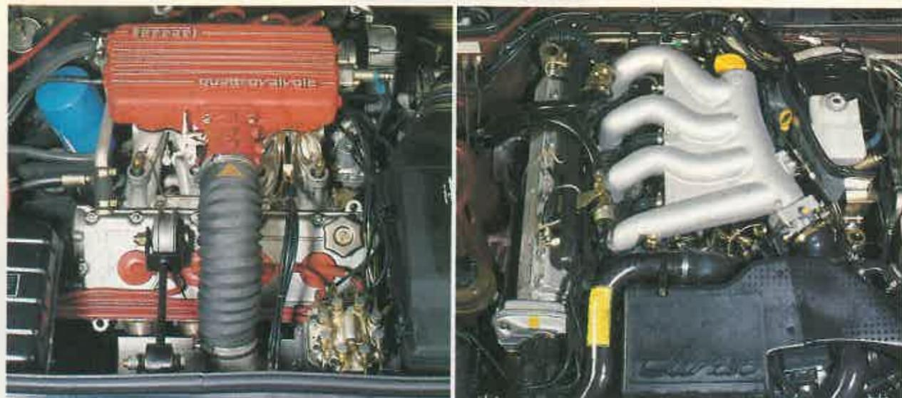
En el Ferrari se utiliza un motor de tres litros. Tiene ocho cilindros y cuatro válvulas, que proporcionan 240 caballos.
