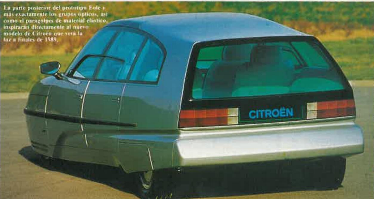
cia aerodinámica; su carrocería va a reproducir la forma de una gota de agua con toda fidelidad y los leves retoques en forma de alerones o faldones que incorporará el conjunto darán al coche una mejor manejabilidad y adherencia al suelo.
