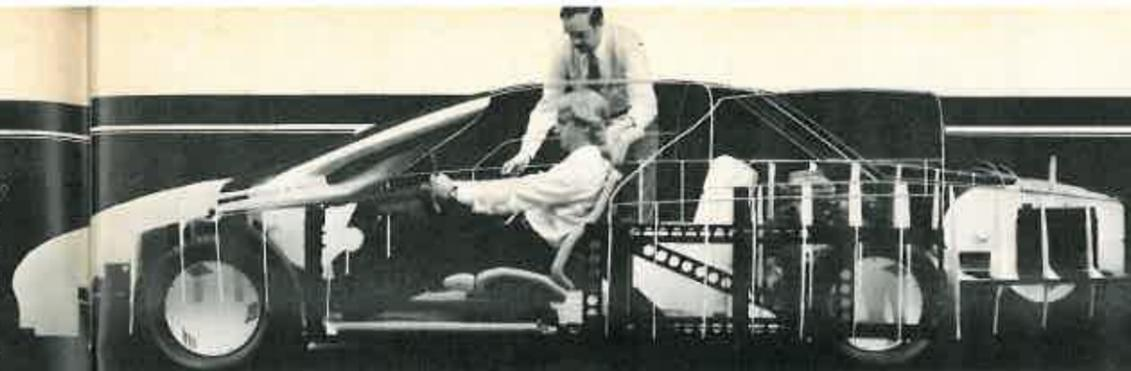
mandos están montados sobre un mecanismo telescópico y desplazable, de forma que el conductor puede realizar las maniobras de entrada y salida sin toparse con el volante.
