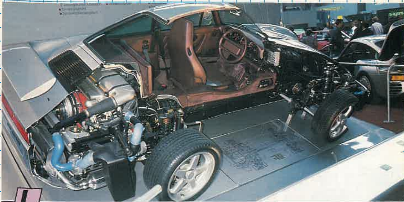
Las entrañas del Porsche 959, al descubierto. Abajo, a la izquierda, el compresor VW GT 40. La espiral azul, al describir un movimiento excéntrico, comprime el aire. En el centro, el motor del BMW M-1, y a la derecha, el salpicadero del BX Digit.
