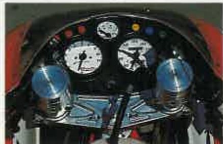
La prolongación de la horquilla son los depósitos de los líquidos de freno y embrague.
