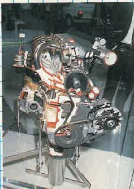
N UEVO motor de mezcla pobre que asegura bajo consumo.
