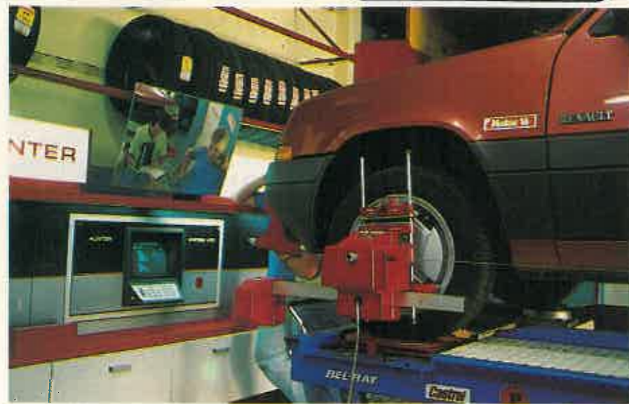
La dirección estaba bien, aunque la convergencia había aumentado un poco. Los neumáticos delanteros se gastaron bastante.
