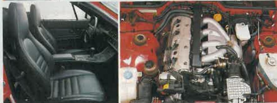
Impresionante el motor de 3 litros y 210 caballos. Posiblemente el 4 cilindros de más cilindrada y potencia de cuantos hoy día se utilizan en coches de serie.
