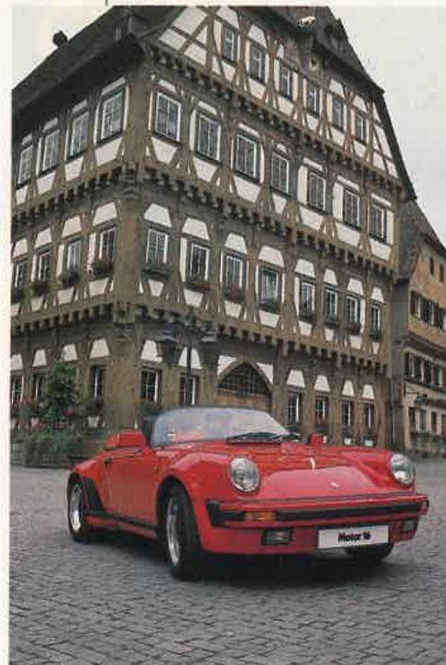
La forma aerodinámica de la cubierta trasera trabaja con eficacia y desvía los remolinos de aire hacia la zona central, hacia el espacio libre entre los hombros de los dos pasajeros. Los técnicos de Porsche han evitado las corrientes de aire que inciden en la nuca.
