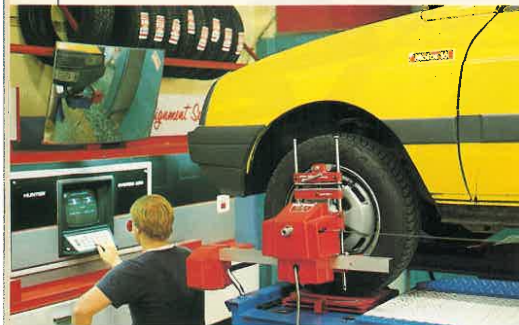
Tras los 15.000 kilómetros se comprobaron las cotas de dirección. La máquina confirmó que todo estaba en su sitio.
