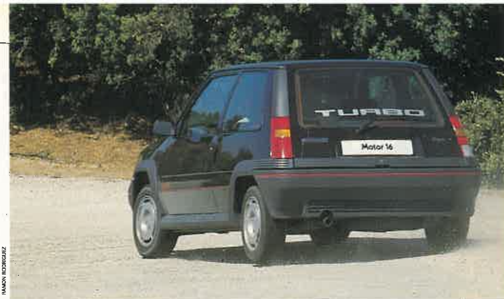
El eje trasero desliza con facilidad y ayuda al conductor a terminar de negociar la curva. Sólo cuando se va al límite este deslizamiento puede hacerse brusco.
