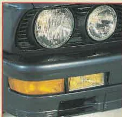
El doble faro delantero es común a los serie 5. La luz está un poco descompensada entre la corta y la larga.
