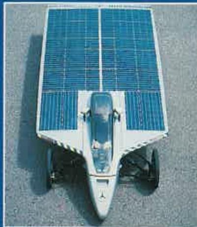
a 85 kilómetros por hora. Su consumo, además, fue realmente bajo: 27,2 vatios cada hora, gracias en parte a un sistema electrónico de regulación que permitía el paso de la energía directamente desde las células solares a los motores, sin descargar prácticamente las baterías. Además, su media horaria fue muy honrosa: 38 kilómetros por hora, que en las etapas más favorables subieron hasta 60.
