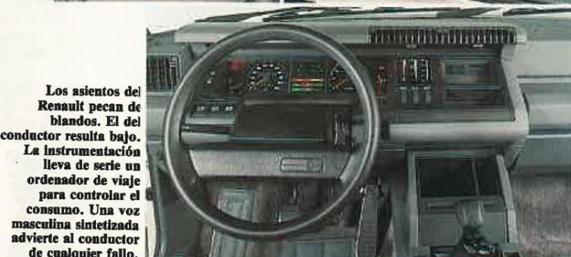
Los asientos del Renault pecan de blandos. El del conductor resulta bajo. La instrumentación lleva de serie un ordenador de viaje para controlar el consumo. Una voz masculina sintetizada advierte al conductor de cualquier fallo.
