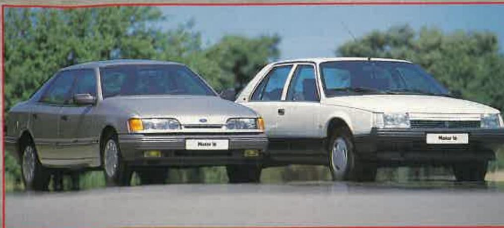
Los dos coches tienen buena aerodinámica. El R-25 tiene un Cx de 0,30; el Scorpio, de 0,33.
