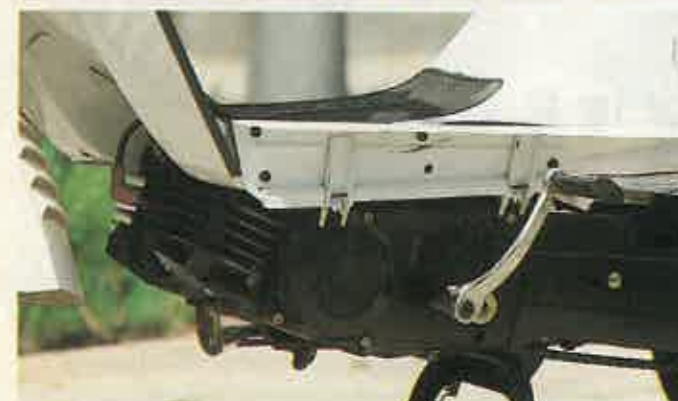
La plataforma reposapiés se dobla, permitiendo girar a los pedales. En el cuadro de instrumentos, con tan sólo el velocímetro-cuentakilómetros, se echa en falta un indicador de nivel de gasolina. El portaequipajes (derecha) es la única posibilidad de llevar algún bulto.
