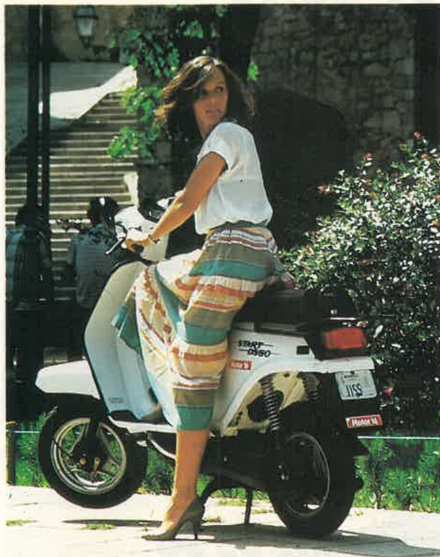
Atractivo el resultado de la DS 50, combinando un chasis de scooter con mecánica de ciclomotor. Las llantas son de aleación, ligeras y atractivas.
