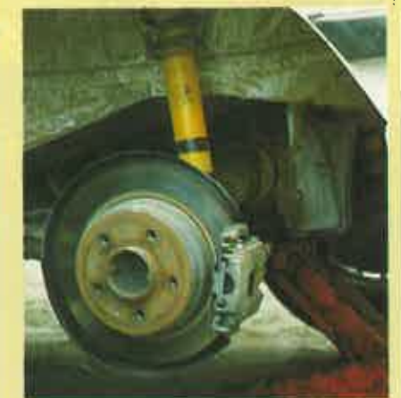
Amortiguadores del M5, asientos «baquet», grupo corto, neumáticos Michelin TRX y ciento cincuenta kilos menos de peso, son las principales diferencias con un BMW 524 turbodiesel de serie.
