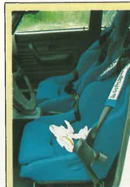
Amortiguadores del M5, asientos «baquet», grupo corto, neumáticos Michelin TRX y ciento cincuenta kilos menos de peso, son las principales diferencias con un BMW 524 turbodiesel de serie.
