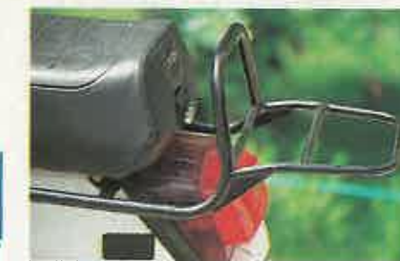
La plataforma reposapiés se dobla, permitiendo girar a los pedales. En el cuadro de instrumentos, con tan sólo el velocímetro-cuentakilómetros, se echa en falta un indicador de nivel de gasolina. El portaequipajes (derecha) es la única posibilidad de llevar algún bulto.
