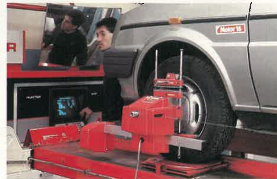
Una vez finalizada la prueba comprobamos el estado de la dirección. Se encontraba abierta y las cotas habían variado
