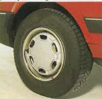
Los neumáticos, 185/70 R 13, proporcionan un agarre de primera línea que permite ir deprisa con unos altos márgenes de seguridad.
