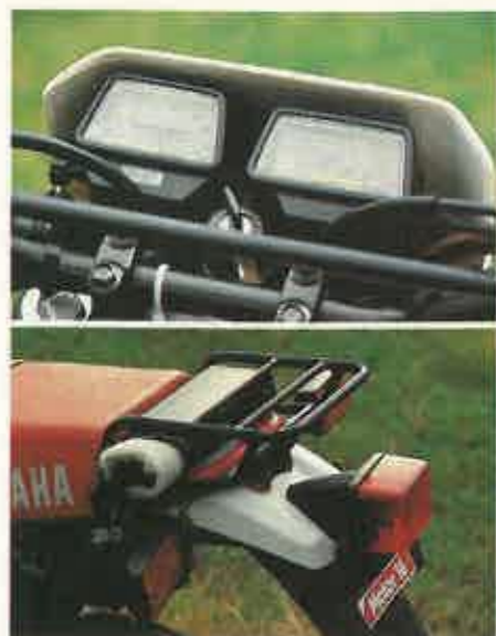
Velocímetro y cuentarrevoluciones son pequeños, pero bien protegidos. El portaequipajes es muy útil. La caja de herramientas incorporada está muy a la vista
