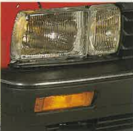
Los paragolpes son de nuevo diseño y llevan una entrada de aire de mayores dimensiones para mejorar la refrigeración.
