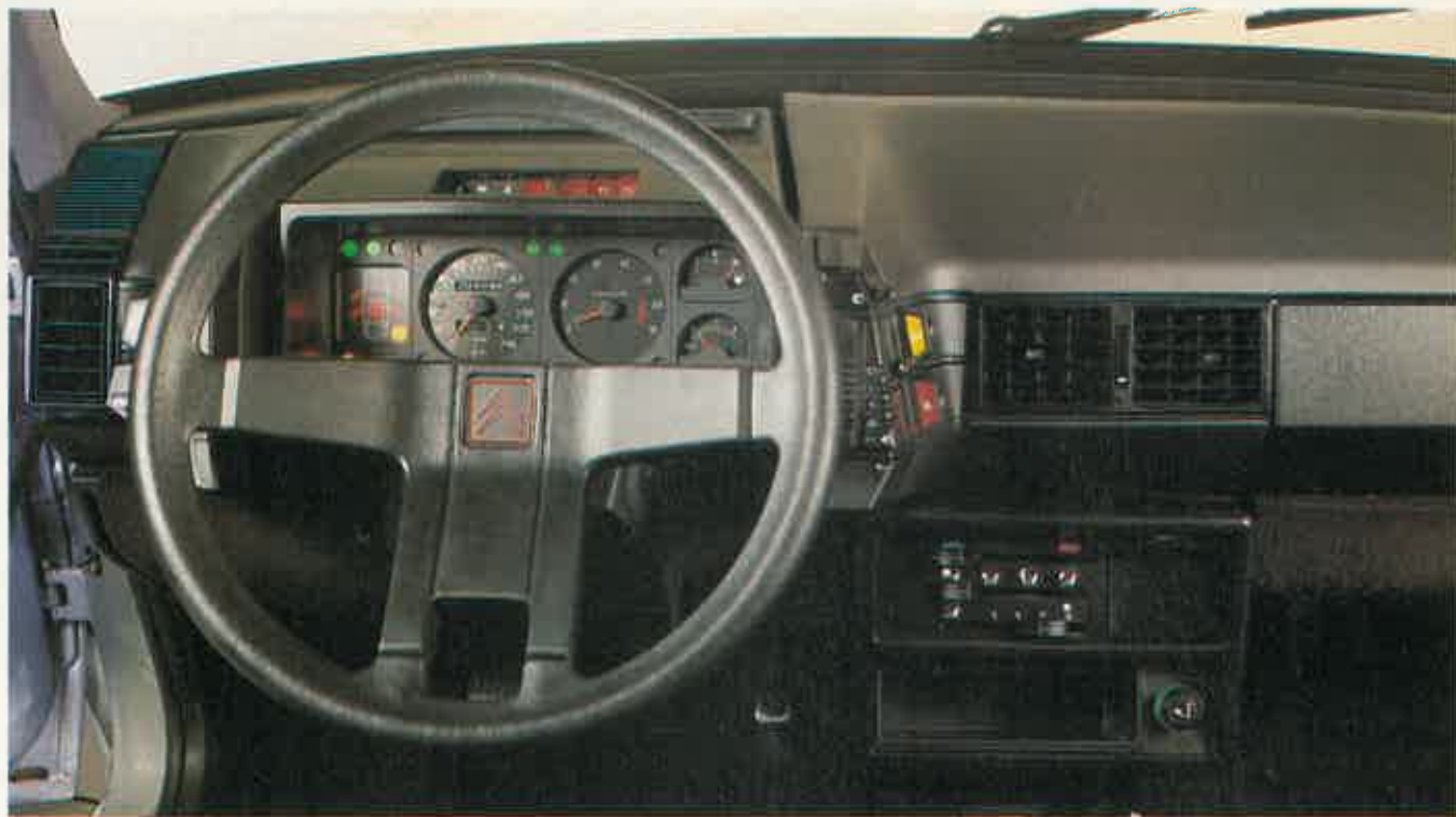
El cuadro de instrumentos se hereda del modelo 19 GT. Faltan los relojes de temperatura de agua y aceite. Los satélites tienen algunas ventajas, pero también inconvenientes. Hace falta un periodo de habituamiento para manejarlo
