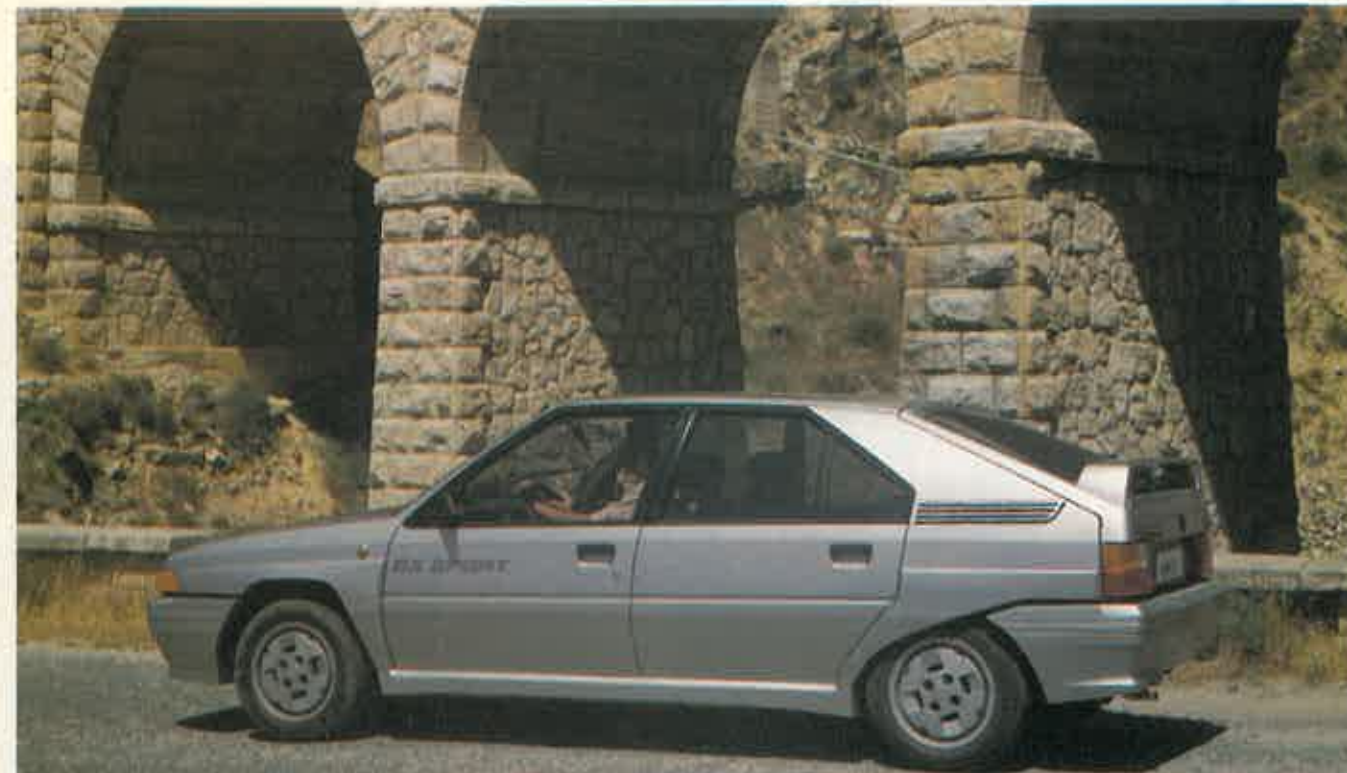
Los aditamentos plásticos están muy logrados. Destaca el llamativo alerón trasero. Un mayor ancho de vías obliga al montaje de aletines. Los estribos le confieren un aspecto muy deportivo
