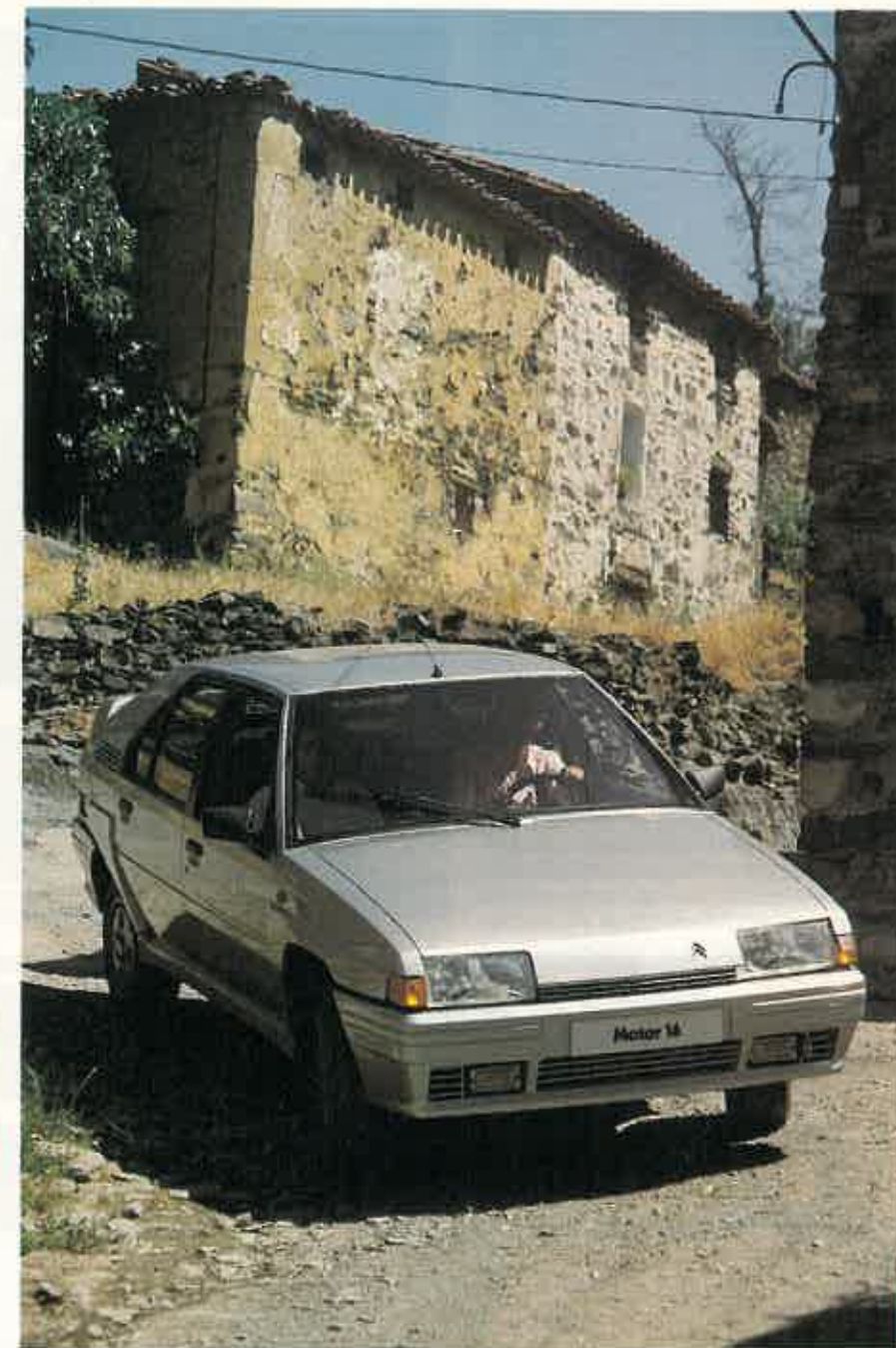
Como en todos los BX, la altura de las suspensiones puede modificarse. En la fotografía, el coche se ha levantado hasta el máximo, para superar un obstáculo.
