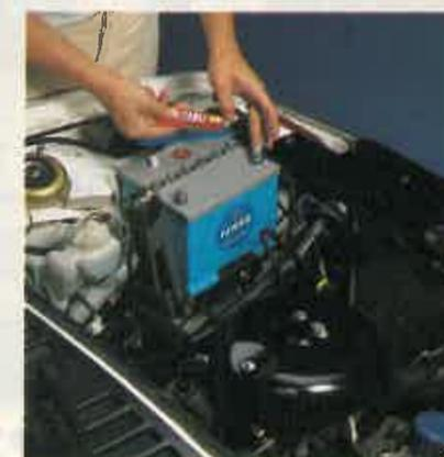
11 Cubra con una gruesa capa de vaselina ambos polos de la batería con el fin de que la corrosión no se reproduzca y a su vez mejore los contactos entre los polos y los terminales.
