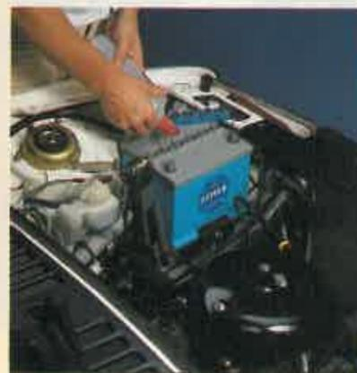
9 Vuelva a montar la batería en su alojamiento y compruebe el nivel del electrolito vaso por vaso, y rellene con agua destilada todos los que presenten un nivel por debajo de la marca.
