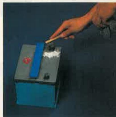
5 Cepille cuidadosamente los bornes de la batería, ya que son piezas frágiles. Limpie el exterior con la disolución de agua y bicarbonato, hasta que no quede nada de corrosión.
