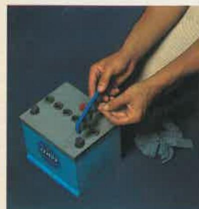
6 Los tapones de los vasos tienen unos orificios para dejar salir los vapores que se producen en la batería. Límpielos con agua y pase un alambre por el orificio si es que alguno está obstruido.
