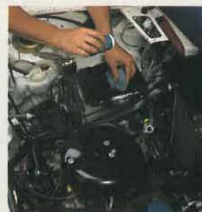
7 Frote enérgicamente todas las superficies afectadas por la corrosión con un trapo empapado en agua con bicarbonato. Para reforzar la acción del bicarbonato, espolvoréelo directamente sobre la superficie tratada.
