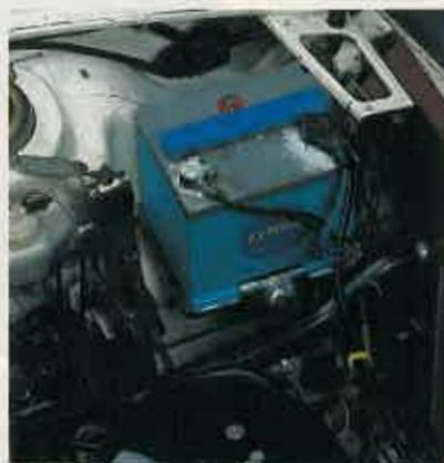
2 Cuando en los bornes de la batería y sus piezas de sujeción aparecen unos depósitos blancos o amarillentos, no hay que retrasar la limpieza, ya que la corrosión puede llegar a romper los soportes.
