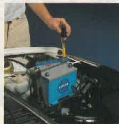
10 Introduzca el densímetro en uno de los vasos y llénelo de líquido apretando la perilla. El flotador le indicará el nivel de carga en que se encuentra su batería.
