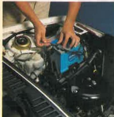
12 Vuelva a conectar los terminales en sus respectivos bornes, cerciorándose de que cada terminal está conectado en su polo. Conectar los cables cambiados podría producir una avería en el sistema eléctrico.
