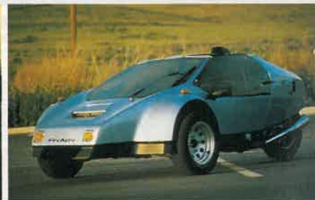
El Fireaero es un cóctel extraño pero efectivo. El motor viene de una moto y el tren delantero de un coche.
