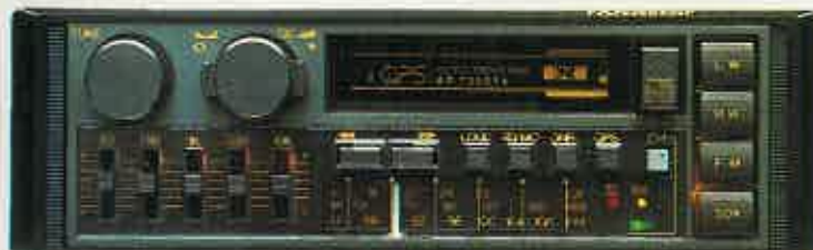
AD-7300 Autoradio OL/OM/FM/FM estéreo, con lector de cassette estéreo Autoreverse, 2 x 22 W.
