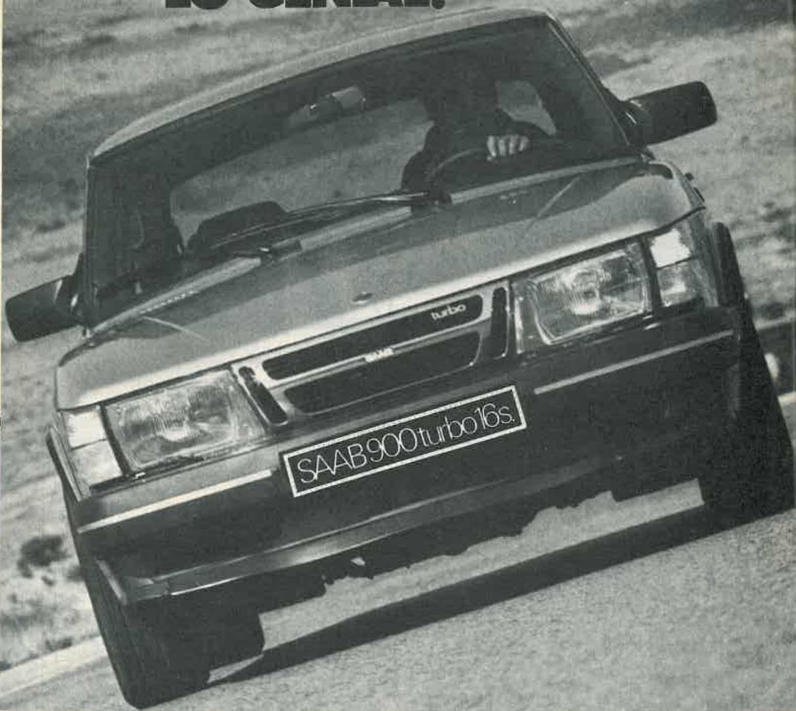
SAAB 900 Turbo 16S: 2000 cm. 3 ; 4 válvulas por cilindro; doble árbol de levas; intercooler y sistema A.P.C.; 175 C.V.; 5 velocidades; 210 km/h; aceleración de 0-100 km: 8,75 sg; consumo 90 km/h: 7,1 l, 120 km/h: 9,5 l; tracción delantera.
