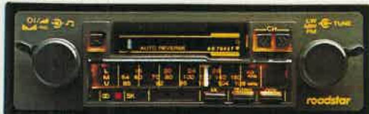
AD-7045 Autoradio OL/OM/FM/FM estéreo, con lector de cassette Autoreverse, 2 x 7 W.
