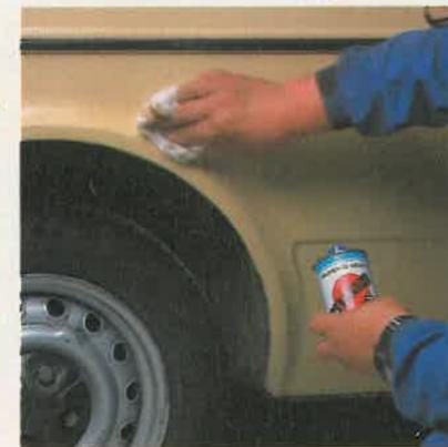
**13** Para el acabado final, frote con otro algodón empapado en abrillantador sobre la parte reparada y sus alrededores o incluso sobre todo el coche, para evitar que se forme una aureola alrededor de la reparación.
