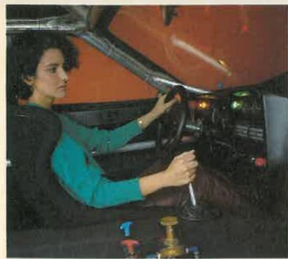
Junto a la palanca del cambio, el conductor dispone de una ruedecilla con la que regula la presión de soplado del turbo, hasta alcanzar 1,45 bares, aumentando o disminuyendo en consecuencia la potencia del motor, que llega a 375 caballos.
