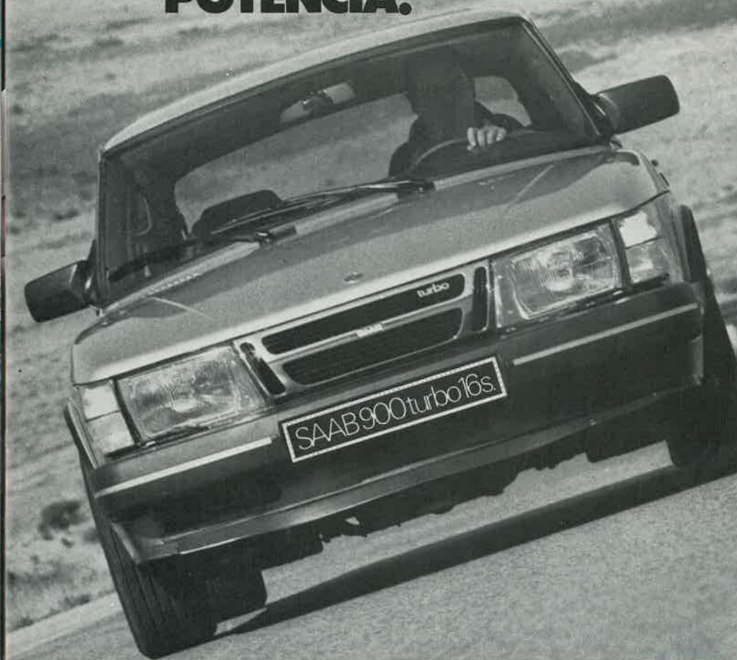
SAAB 900 Turbo 16s: 2000 cm<sup>3</sup>; 4 válvulas por cilindro; doble árbol de levas; intercooler y sistema A.P.C.; 175 C.V.; 5 velocidades; 210 km/h; aceleración de 0-100 km: 8,75sg; consumo 90 km/h: 7,1 l, 120 km/h: 9,5 l; tracción delantera.
