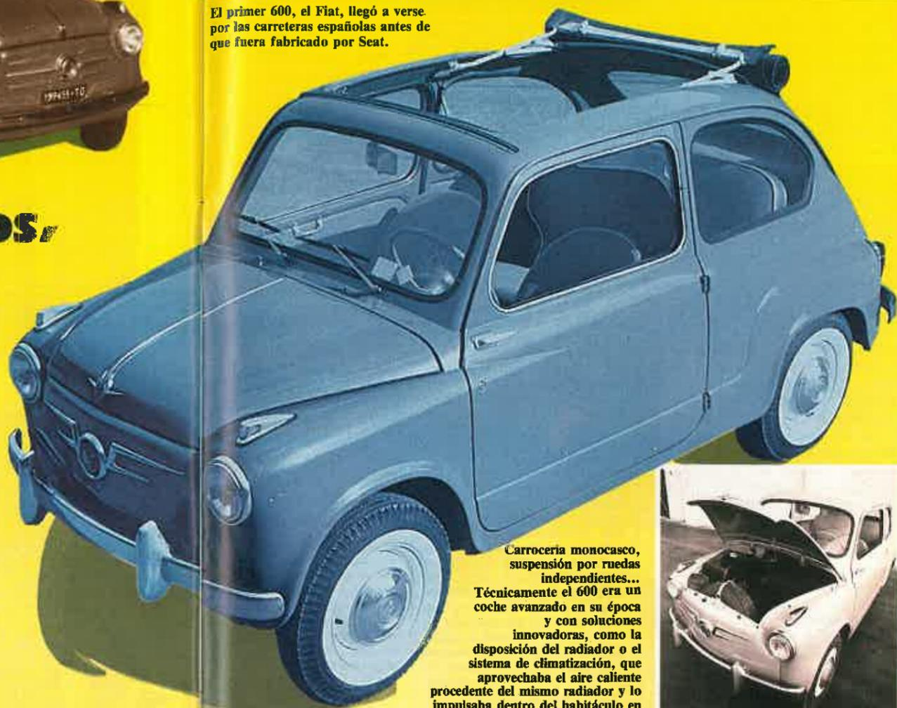
Carrocería monocasco, suspensión por ruedas independientes... Técnicamente el 600 era un coche avanzado en su época y con soluciones innovadoras, como la disposición del radiador o el sistema de climatización, que aprovechaba el aire caliente procedente del mismo radiador y lo impulsaba dentro del habitáculo en el sentido contrario al de la marcha.
