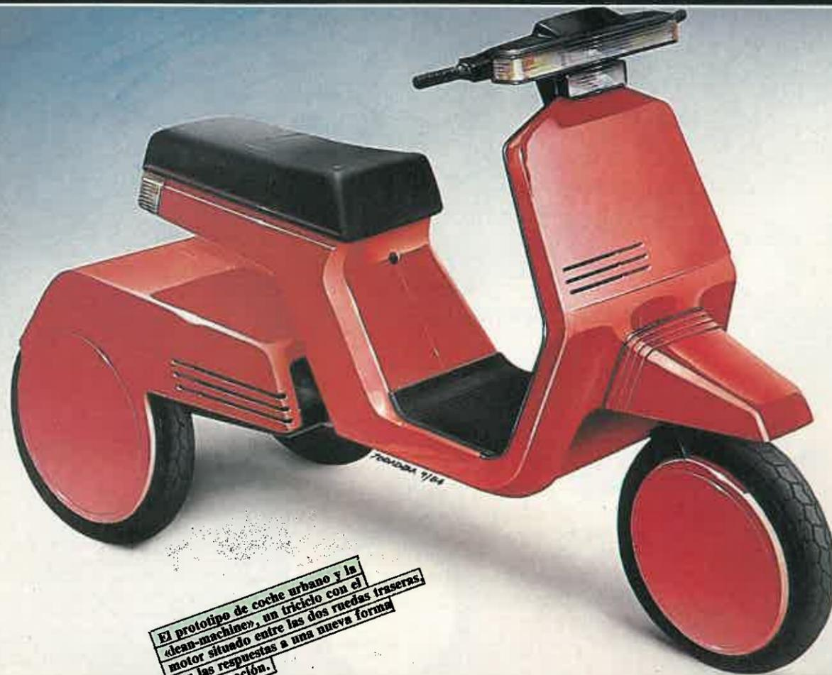
El prototipo de coche urbano y la «lean machine», un triciclo con el motor situado entre las dos ruedas traseras, son las respuestas a una nueva forma de automoción.
