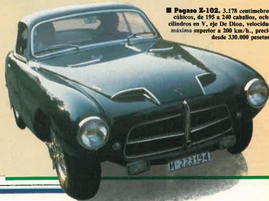
■ Pegaso Z-102. 3.178 centímetros cúbicos, de 195 a 240 caballos, ocho cilindros en V, eje De Dion, velocidad máxima superior a 200 km/h., precio desde 330.000 pesetas.
