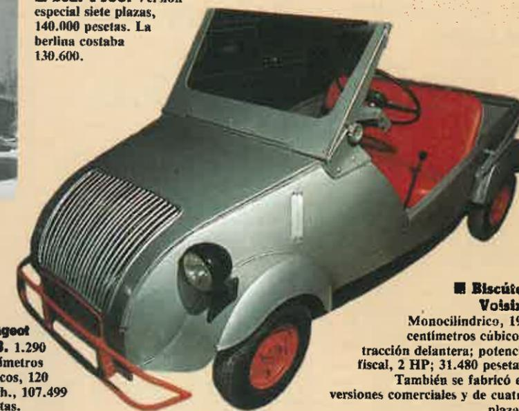
■ Biscúter Voisin. Monocilíndrico, 197 centímetros cúbicos, tracción delantera; potencia fiscal, 2 HP; 31.480 pesetas. También se fabricó en versiones comerciales y de cuatro plazas.
