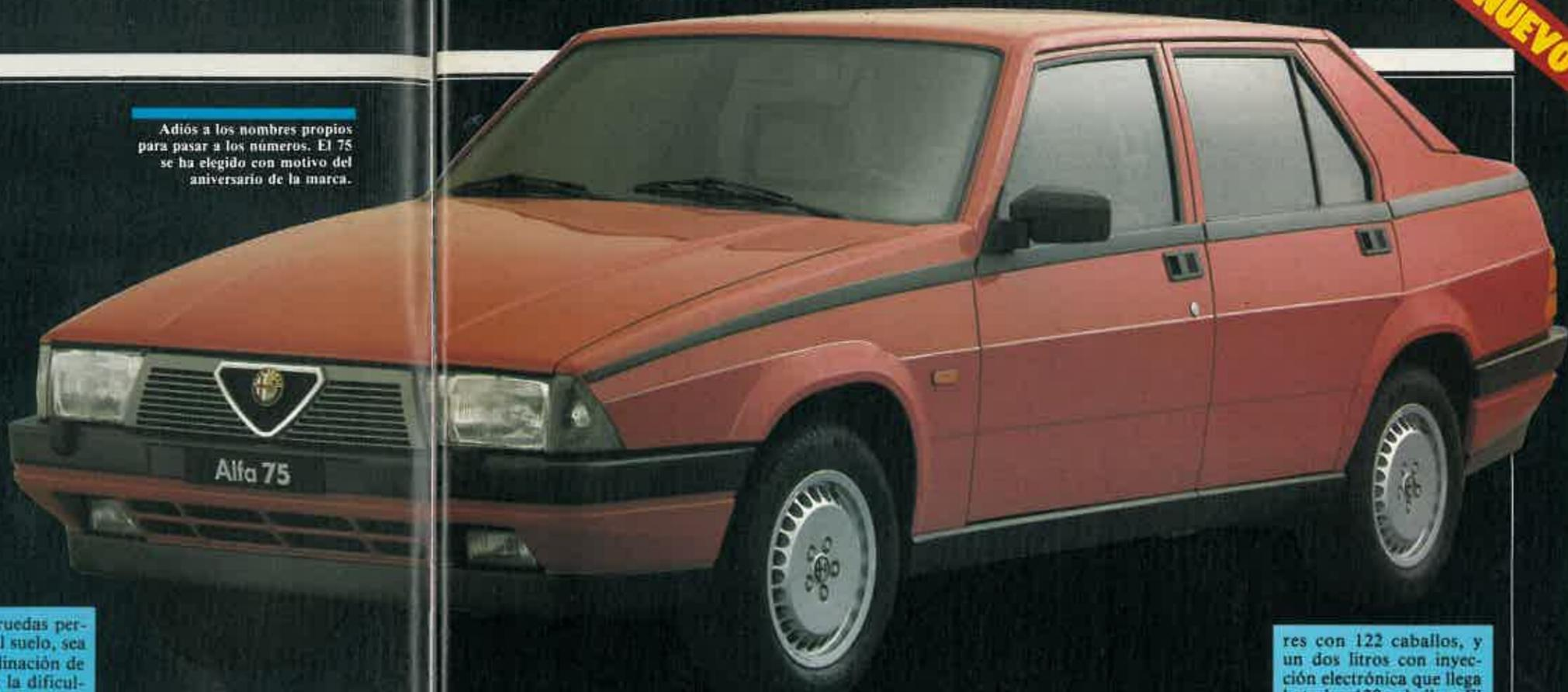
res con 122 caballos, y un dos litros con inyección electrónica que llega hasta los 130 caballos. El motor diesel será un dos litros, que alcanzará los 100 caballos de potencia, gracias al empuje del turbo. El Alfa 75 turbodiesel podrá superar con cierta facilidad los 170 kilómetros por hora.
