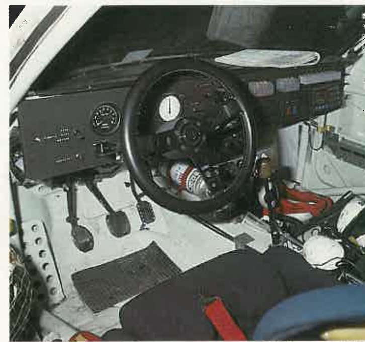
Un interior espartano, sobre el que destaca el gran reloj blanco que indica la presión de soplado del turbo.
