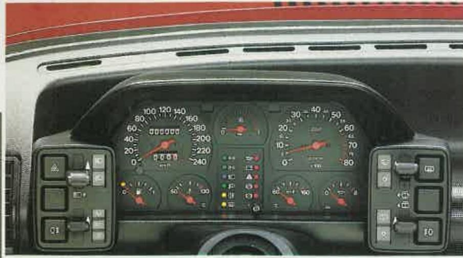
Cuadro de instrumentos muy completo. Junto al manómetro de presión del turbo hay otro de aceite
