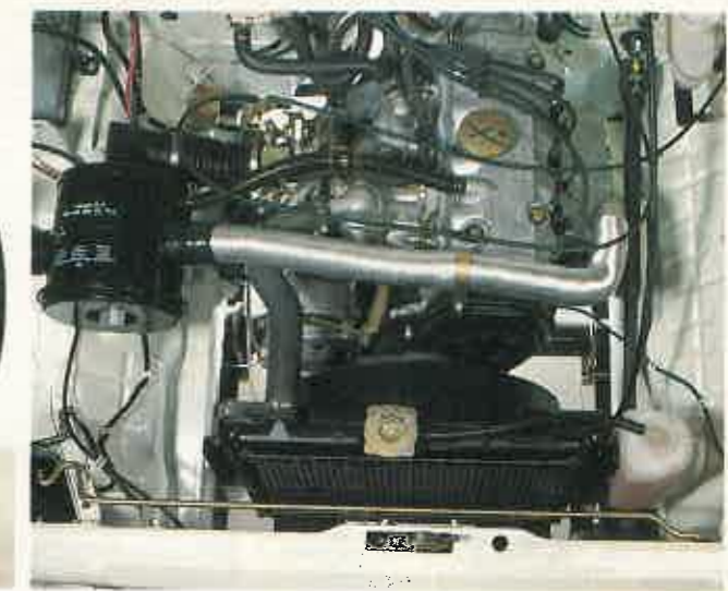
Las partes eléctricas están protegidas del agua Este pequeño corazón mueve con brío los casi 900 kg. del Suzuki
