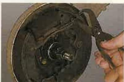
6 Una vez que el tambor está fuera, con los alicates para los muelles afloje las zapatas. Para ello introduzca la parte curvada en el extremo del muelle y, apoyando la otra punta del alicate en la zapata, extráigalo.
