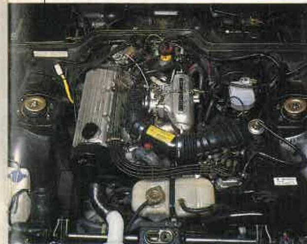
El motor Audi de cuatro cilindros en línea, refrigerado por agua, es el primer argumento del 924. Es suave, elástico y da 125 caballos de pura raza. Su disposición longitudinal en el coche, con la caja de cambios sobre el eje posterior, determina un comportamiento crítico en carreteras viradas.
