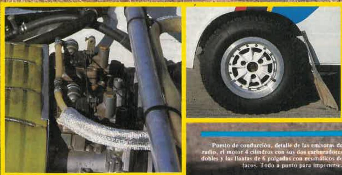
Puesto de conducción, detalle de las emisoras de radio, el motor 4 cilindros con sus dos carburadores dobles y las llantas de 6 pulgadas con neumáticos de tacos. Todo a punto para imponerse.
