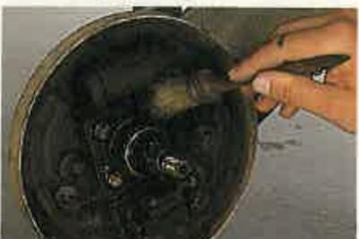
9 Limpie bien todo el interior del tambor y los mecanismos. Mire que no haya ninguna fuga de líquido. Lije los forros de las zapatas o si están gastadas sustitúyalas. Engrase los cojinetes del buje y ponga grasa en en la cazoleta.
