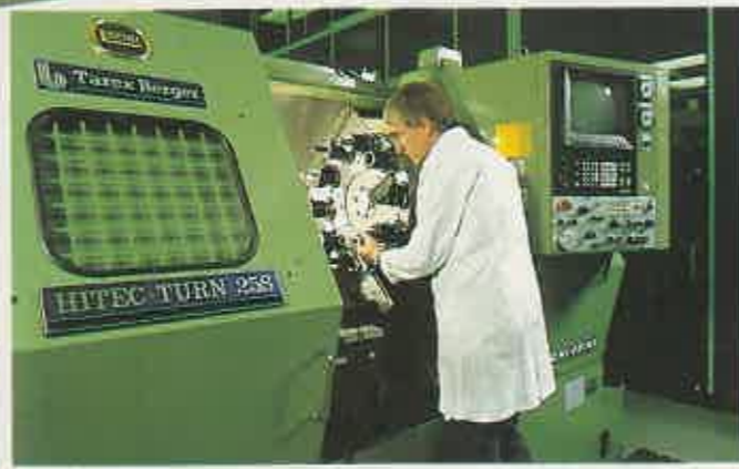
Tornos con control digital permiten elaborar piezas complejas.
