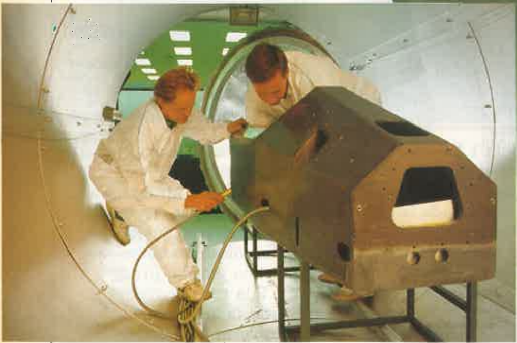
En este autoclave cuecen los chasis de fibra de carbono. La manipulación se realiza por medio de una tecnología muy sofisticada
