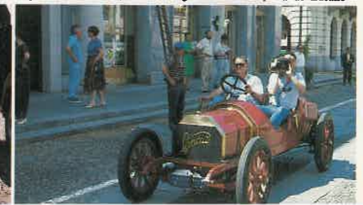
El Alfa Corsa arranca a manivela, después de cebar el carburador. A pesar de su edad, camina alegremente en la plaza de Lucano
