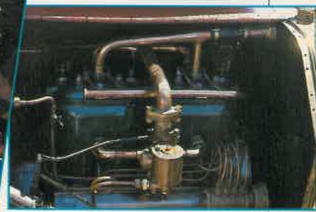
El motor del Alfa Corsa es un cuatro cilindros en línea de 2,5 litros de cubicaje, que ya por aquel entonces desarrollaba una potencia de 45 caballos. También destaca su caja de cambios de cuatro marchas para delante y una hacia atrás.
