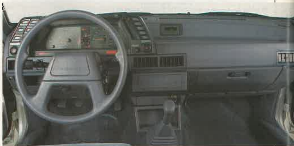
El cuadro del Subaru es tan especial como el aspecto exterior del coche. Entre la palanca de cambios y el freno de mano, se instala el mando 4WD.
