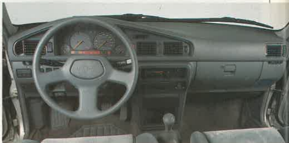
Las líneas suaves caracterizan el cuadro de mandos del Mazda. En este caso la dureza de suspensión se controla desde la izquierda del volante.
