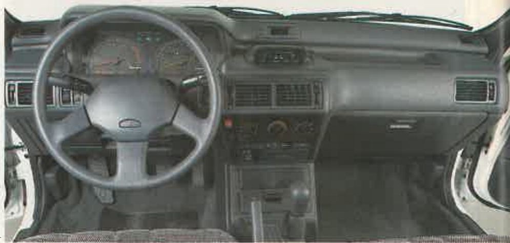
El cuadro del Mitsubishi, como el de todos, está repleto de detalles. Destaca el control de la suspensión electrónica a la derecha del cuadro.
