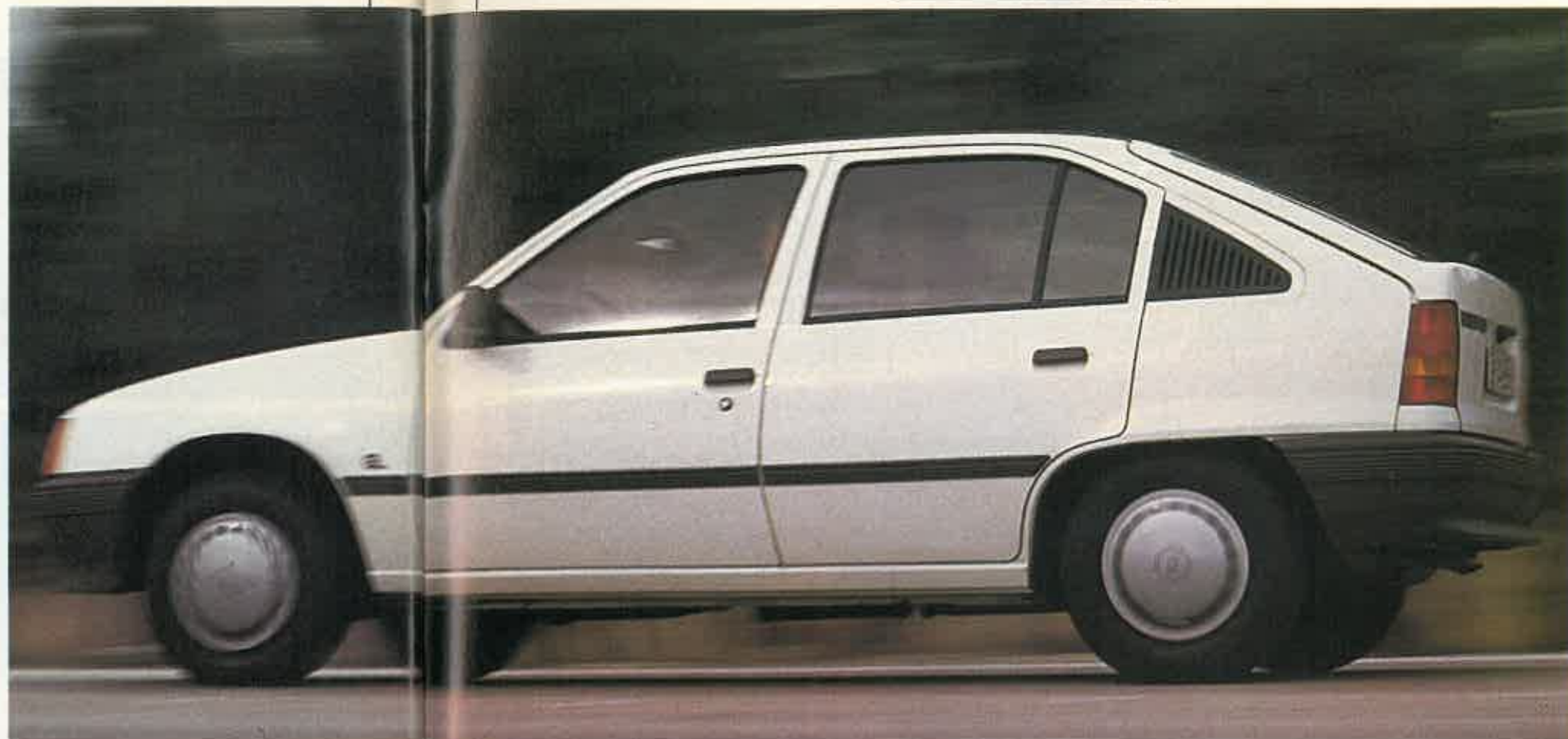
Los rasgos redondeados de esta carrocería mejoran la aerodinámica.
