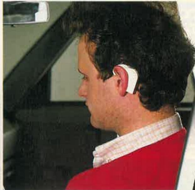
en fracción de segundos, y el zumbador comienza a emitir la señal. Este aparato funciona con una pequeña batería alimentada por una pila de 1,5 vatios, que permite quince horas de funcionamiento (sonando el zumbador continuamente). Se vende, ya con la pi-
