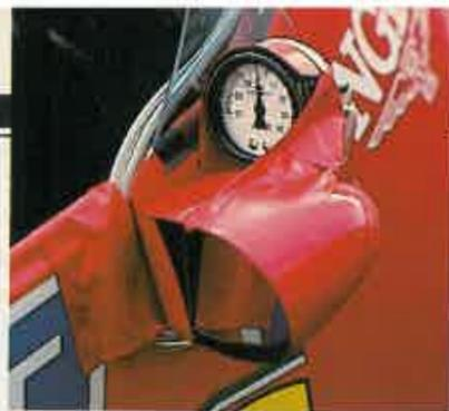
Medidor de vacío en el Ferrari. Se trata de medir hasta el último detalle
