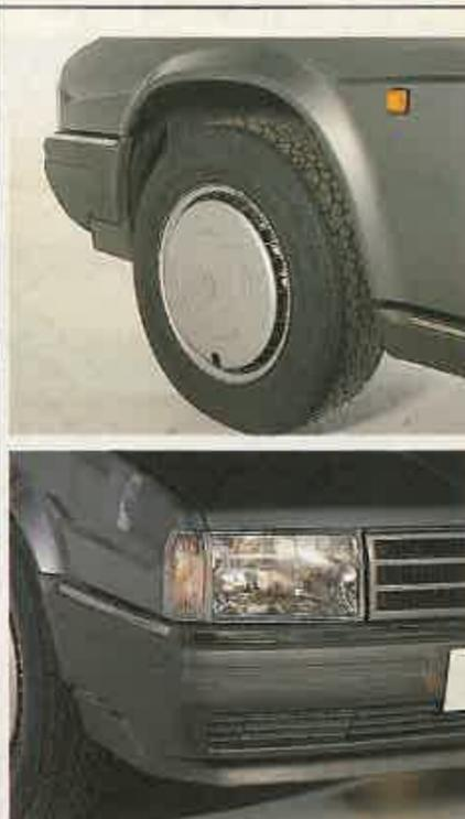
El Alfa 90 tiende a irse de morro a la entrada de las curvas. Detalle del spoiler delantero móvil en función de la velocidad
