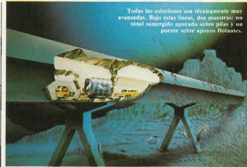
Todas las soluciones son técnicamente muy avanzadas. Bajo estas líneas, dos muestras: un túnel sumergido apoyado sobre pilas y un puente sobre apoyos flotantes.
