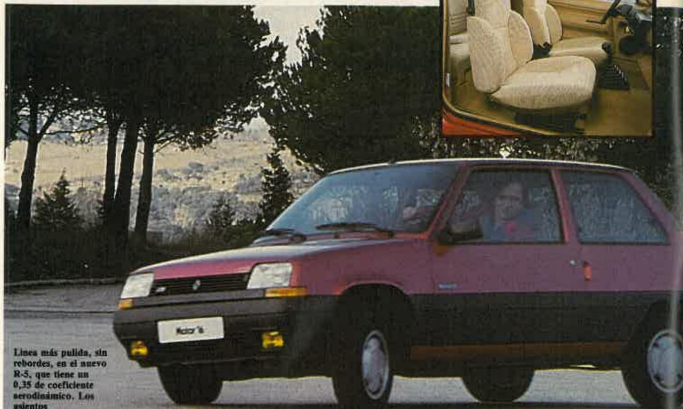
Línea más pulida, sin rebordes, en el nuevo R-5, que tiene un 0,35 de coeficiente aerodinámico. Los asientos pétalo-monorrail dificultan el acceso a las plazas traseras.
