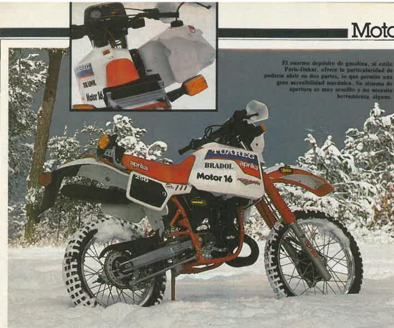
El enorme depósito de gasolina, al estilo París-Dakar, ofrece la particularidad de poderse abrir en dos partes, lo que permite una gran accesibilidad mecánica. Su sistema de apertura es muy sencillo y no necesita herramienta alguna.
