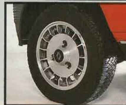
Las llantas del Super-5 (arriba) son de aleación, y su diseño permite una aceptable refrigeración de los frenos. Montan neumáticos de medida 165/65. En el TX, con la misma medida de llanta, los neumáticos son de perfil 70.
