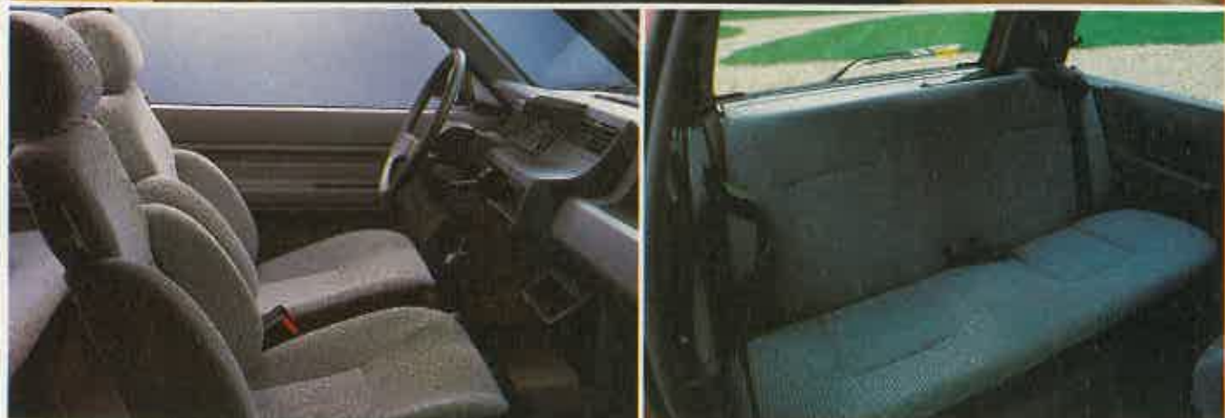
Los interiores son de nuevo diseño, siguiendo el estilo de la marca ya introducido en los R-11 y R-25. Los asientos son del tipo monorail, muy envolventes, con reposacabezas y asiento trasero partido en las versiones más equipadas.
