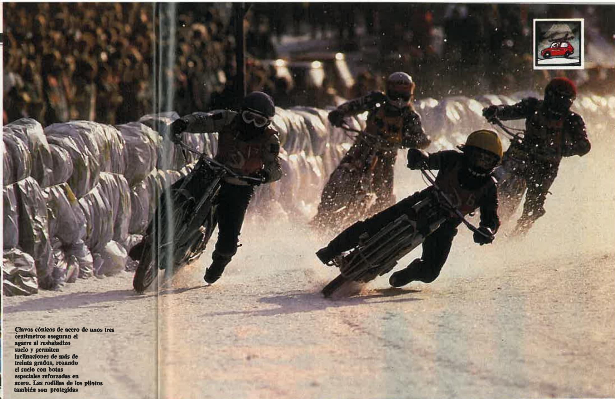
Clavos cónicos de acero de unos tres centímetros aseguran el agarre al resbaladizo suelo y permiten inclinaciones de más de treinta grados, rozando el suelo con botas especiales reforzadas en acero. Las rodillas de los pilotos también son protegidas
