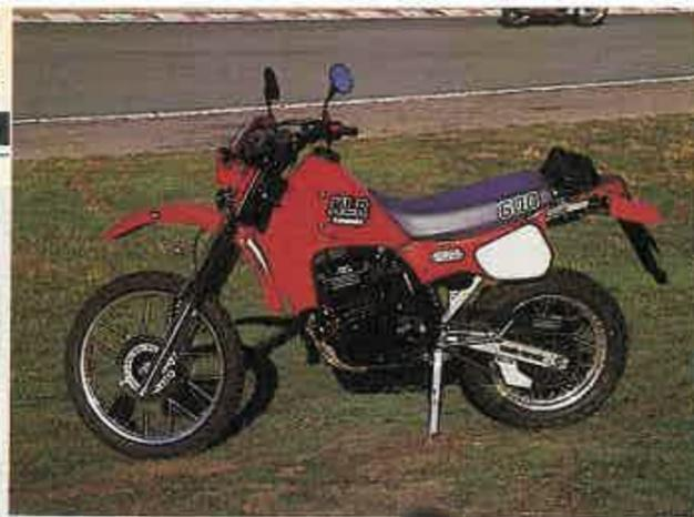
Un poderoso motor caracteriza a la KL-600-R. Cuatro válvulas por cilindro, doble árbol y refrigeración por agua.
