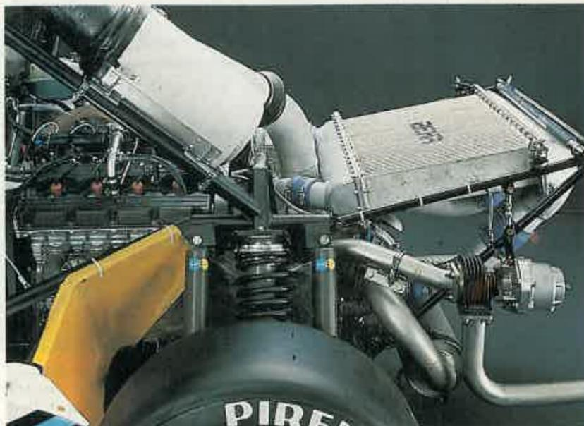
Impresionante el aspecto del intercooler, para permitir la refrigeración del aire. Este, es comprimido sucesivamente por un compresor volumétrico y un turbo.
