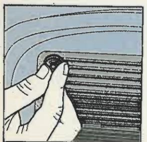
Junto con la toma de aire hay cuatro arandelas planas y otras cuatro que se quedan aprisionadas en los pivotes de plástico. Introduzca primero las arandelas planas y después las de sujeción hasta donde pueda con la mano.
