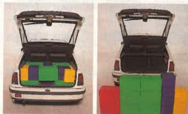
Cubijaje del maletero de un coche. Los bloques de poliestireno nos ayudan a obtener la capacidad máxima.
