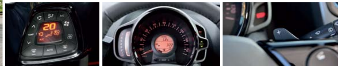
▲ El climatizador es de serie con el acabado 'x-play'. El cuadro de mandos es solidario con la columna de la dirección, que sólo se regula en altura. Las levas son de serie si optamos por la caja automática.
