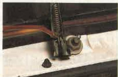
Compruebe que el muelle del brazo conserva suficiente tensión; si está flojo y no ejerce suficiente tensión, cambie el brazo. Engrase la articulación del brazo y verifique que éste se mueve sin ninguna resistencia.
