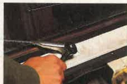
Para quitar los brazos del limpiaparabrisas hay que aflojar un tornillo que lo fija al eje. En otros modelos basta con tirar del brazo, ya que simplemente van cogidos por unos muelles sin ningún tipo de tornillo.
