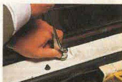
Cuando haya quitado el tornillo, quite las arandelas y tire del brazo para sacarlo del eje estriado. Si está muy agarrotado, puede darle algunos golpecitos con un taco de madera o con el mango de un martillo para que se suelte.
