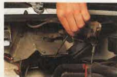
El primer paso es reparar todos los tornillos que fijan el motorcito a su soporte. La unión suele ser un poco elástica mediante unos toques de goma. Si el motor no está bien sujeto, los limpiaparabrisas no harán todo el recorrido.
