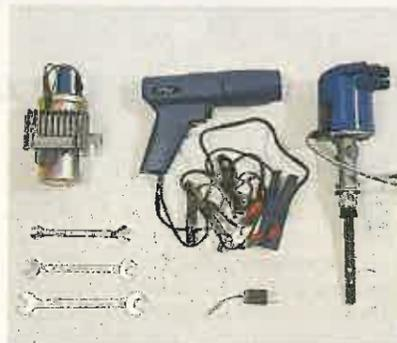
1 El encendido electrónico tiene dos componentes: el distribuidor y la bobina con el integrador electrónico. También es necesaria una lámpara estroboscópica para calar en su punto el distribuidor. Por último, tres llaves fijas.
