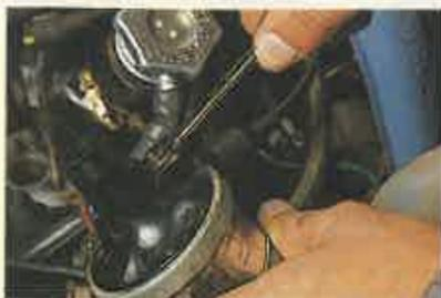
5 Afloje los dos tornillos que fijan la bobina en su lugar y extráigala. Quite el cable de alta tensión y desmonte los dos terminales, marcando cuál va al depósito y cuál va al negativo, así como el que va al cuentarrevoluciones.
