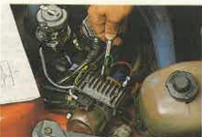
9 Instale la nueva bobina en el mismo alojamiento de la convencional y conecte los cables tal y como viene indicado en las instrucciones del encendido. Para el cuentarrevoluciones tendrá que intercalar un condensador.
