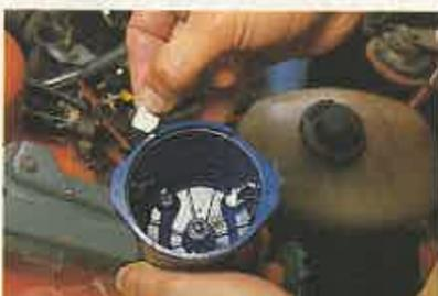
6 Tome la tapa del distribuidor del encendido electrónico. Identifique cuál de los cuatro contactos del interior corresponde al cilindro número uno. Marque en la parte exterior el lugar correspondiente a dicho cilindro.
