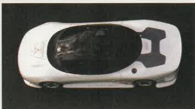
El capítulo aerodinámico tiene una importancia especial en el prototipo de Mitsubishi. Los técnicos han conseguido un coeficiente de resistencia a la penetración en el aire, un Cx, igual a 0,20
