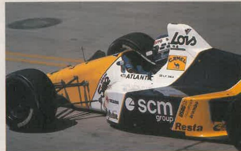
como en el Benetton y la centralita electrónica que regula la inyección y el encendido está fijada sobre los pontones. El motor Cosworth DFR se ve alimentado por una toma de aire del tipo periscopio, separada de la carrocería. Sin embargo, por lo que se ha podido ver en México y Phoenix, no está bien estudiada la disipación térmica del motor. En ambas carreras fue preciso des-
