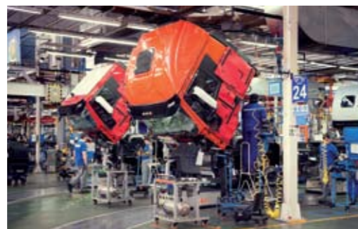
▲▼ Al no producir stock, todos los camiones que se fabrican en Madrid tienen dueño y uno por uno se ajustan a las especificaciones de la hoja de pedido. La factoría tiene una plantilla de 3.000 personas en producción en dos turnos y de la línea de montaje sale un camión cada 8,5 minutos.
