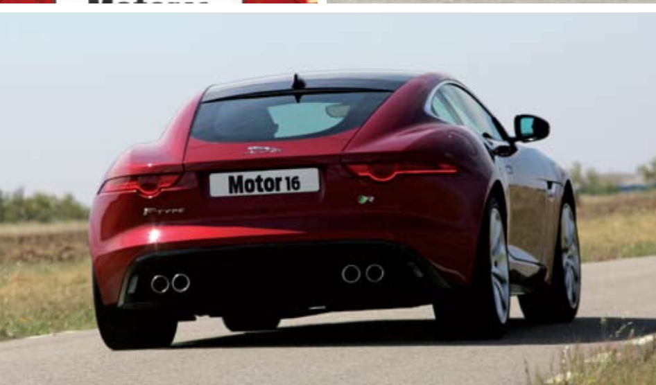
▲ El alerón emerge a 112 km/h y se oculta al bajar de 80. Genera una carga de 120 kilos. El equipo de sonido Meridian es magnífico, pero me quedo con el del V8.
