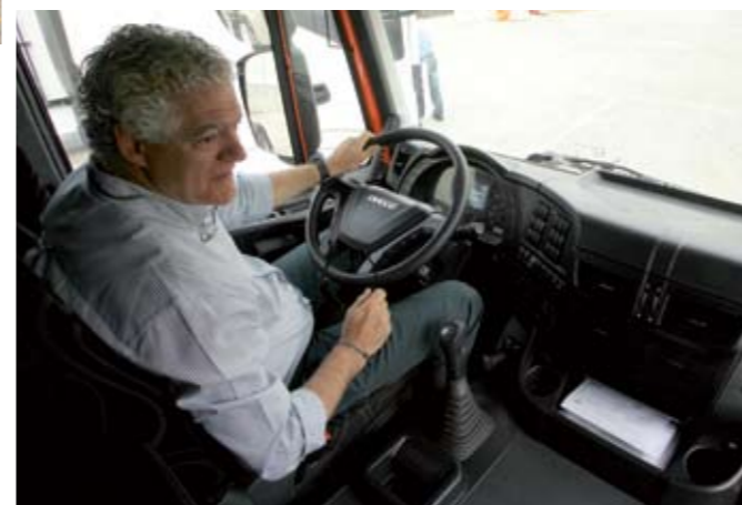
▲ El puesto de conducción de un camión Stralis de gas no tiene nada que envidiar al de cualquier automóvil de gama alta. La única diferencia en el cuadro respecto a un Stralis de motor tradicional es la tecla de paso a los depósitos de GNC de reserva. Su motor rinde 330 caballos.
