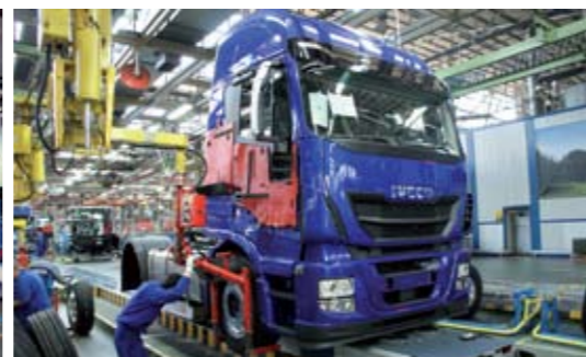
▲▼ Al no producir stock, todos los camiones que se fabrican en Madrid tienen dueño y uno por uno se ajustan a las especificaciones de la hoja de pedido. La factoría tiene una plantilla de 3.000 personas en producción en dos turnos y de la línea de montaje sale un camión cada 8,5 minutos.
