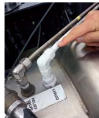
▲ El GNL se almacena a -130° y a 9 bares para que ocupe menos y quepa más. Hasta el tubo se congela, pero antes de ser inyectado en el motor pasa a estado gaseoso.
