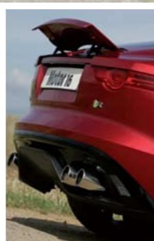
▲ El alerón emerge a 112 km/h y se oculta al bajar de 80. Genera una carga de 120 kilos. El equipo de sonido Meridian es magnífico, pero me quedo con el del V8.
