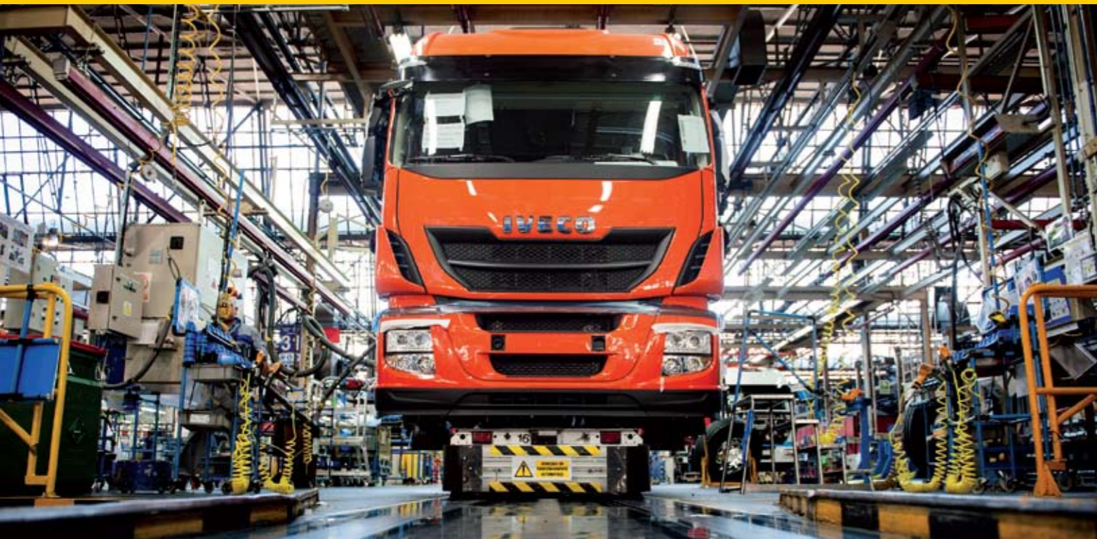
▲▼ Al no producir stock, todos los camiones que se fabrican en Madrid tienen dueño y uno por uno se ajustan a las especificaciones de la hoja de pedido. La factoría tiene una plantilla de 3.000 personas en producción en dos turnos y de la línea de montaje sale un camión cada 8,5 minutos.
