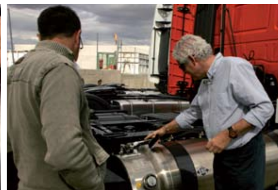
▲ El GNL se almacena a -130° y a 9 bares para que ocupe menos y quepa más. Hasta el tubo se congela, pero antes de ser inyectado en el motor pasa a estado gaseoso.
