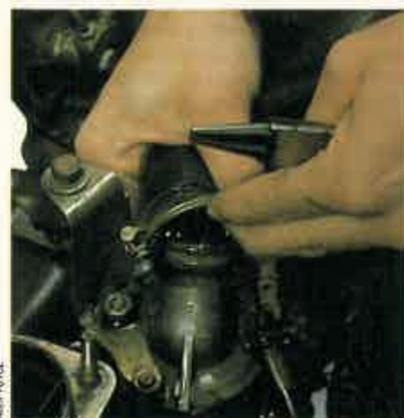
**3** Haga girar el manguito sobre el termostato hasta que quede suelto, y entonces tire de él suavemente. Al sacarlo le caerá todo el líquido refrigerante que hay en su interior. Recuerde que al terminar habrá que reponerlo.
