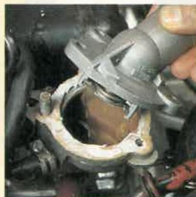
**9** Ponga el nuevo termostato, si es que ha tenido que cambiarlo, y presione ligeramente sobre la junta, para que ésta quede bien sentada. Vuelva a levantar el termostato y observe si hay alguna arruga en la junta.
