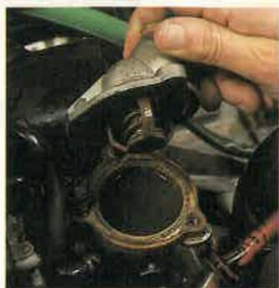
**5** Cuando haya sacado todos los tornillos que sujetan el termostato, saque éste de su alojamiento. Compruebe su funcionamiento sumergiéndolo en agua hirviendo. Si no funciona, sustitúyalo.
