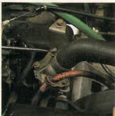
**2** Con el destornillador afloje la abrazadera del manguito que sale del termostato. Cuando el tornillo esté totalmente suelto, afloje la abrazadera con los alicates hasta que ésta gire sobre el manguito.
