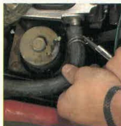
**14** Unte algo de jabón en la boca del tubo para favorecer la operación de montaje del manguito. A la vez que empuja el tubo hacia dentro, apriete con los alicates para abrir la abrazadera. No olvide rellenar el circuito.
