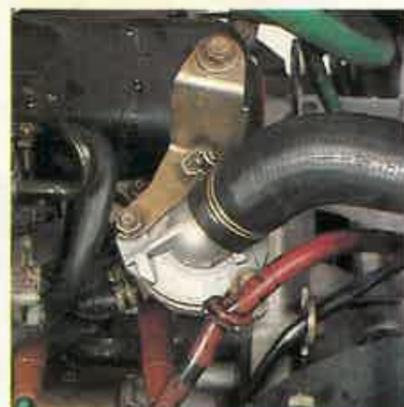
**11** Vuelva a colocar el manguito en su posición original. Si no entra fácilmente, ponga un poco de jabón en la boca del tubo para facilitar su entrada. Apriete la abrazadera para que no haya pérdidas.
