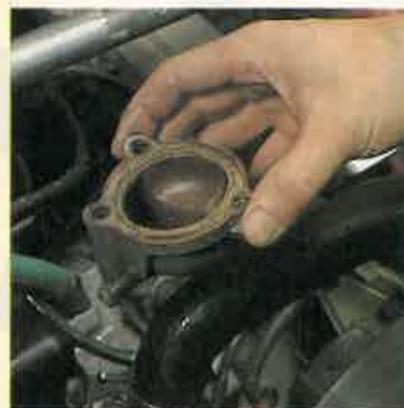
**6** Aproveche que ha sacado el termostato para cambiar todas las juntas. Saque el soporte del termostato y retire las juntas viejas, tanto la que tiene encima como la que hay debajo.
