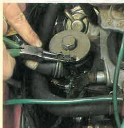
**12** Si hay algún manguito dañado, hay que proceder a su sustitución rápidamente. Afloje la abrazadera con los alicates y tire del tubo suavemente hasta que salga de su alojamiento. También de aquí saldrá líquido.
