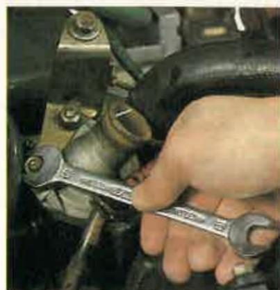
**4** Con la llave fija afloje los tornillos que sujetan el termostato al bloque motor. Si dispone de llaves de tubo, la operación le resultará más sencilla, aunque depende de la ubicación del termostato.
