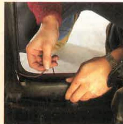
**9** Continúe pasando el cable por detrás de los paneles traseros, fijándolo en algún punto. Cuando llegue al marco de la puerta, afloje los tornillos que sujetan el embellecedor e introduzca el cable por debajo.
