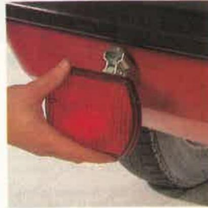
**5** Apriete firmemente la tuerca del piloto, de forma que éste no se mueva. No olvide poner la arandela partida que viene en el piloto, ya que si no con las vibraciones se podría aflojar el piloto.
