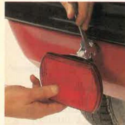
**6** Oriente el piloto de forma que quede perpendicular a la carretera, que no apunte hacia arriba ni hacia abajo. Cuando esté orientado, apriete los tornillos de la articulación.
