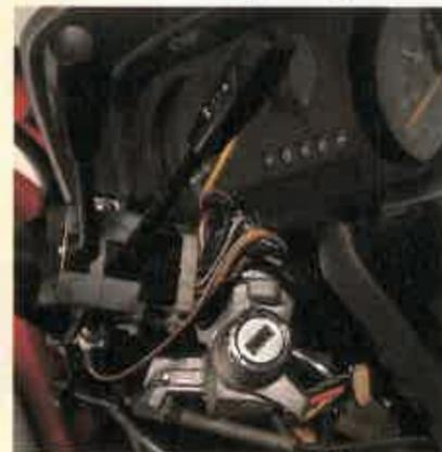
**12** Desmonte la carcasa bajo la que se encuentran los conmutadores de las luces de cruce, y tantee hasta encontrar el cable de las luces de cruce. De este cable tome una derivación para alimentar el piloto.
