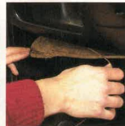
**10** Cuando llegue al puesto del conductor lleve el cable por debajo del cuadro hasta el punto en el que haya decidido colocar el interruptor. Después de esto coloque de nuevo todos los paneles.
