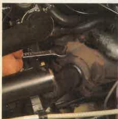
**12** Comience apretando los tornillos del colector de escape, pero sin que la unión quede firmemente apretada para que haya posibilidad de mover el ajuste, una vez que haya unido la parte inferior.
