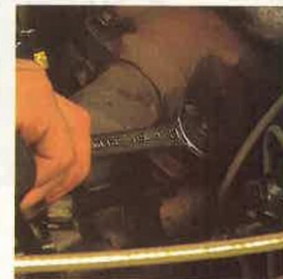
**8** Después de haber rociado con aceite ligero los tornillos que fijan el colector de escape al tubo, aflójelos. Tenga las mismas precauciones que con el otro tornillo y aflójelo tomando las mismas precauciones.
