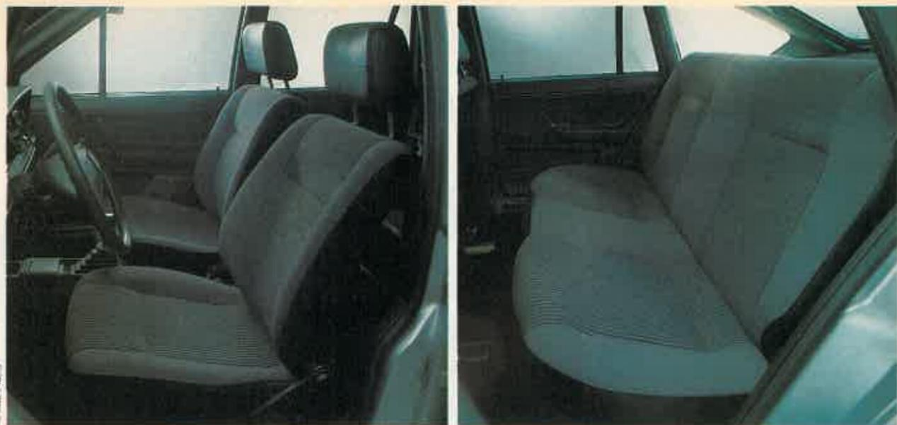
Los asientos del Passat dejan bastante que desear. Los delanteros no tienen sujeción lateral y el respaldo tiene poco apoyo a la altura de los riñones. El volante es grande y su posición es más vertical de lo normal
