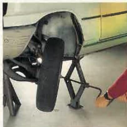
**2** Eleve el coche con el gato e introduzca la borriqueta o el calzo que vaya a utilizar, bajo el coche, apoyándolo en algún punto fuerte, no en la chapa de los bajos, ya que ésta es de escasa resistencia.
