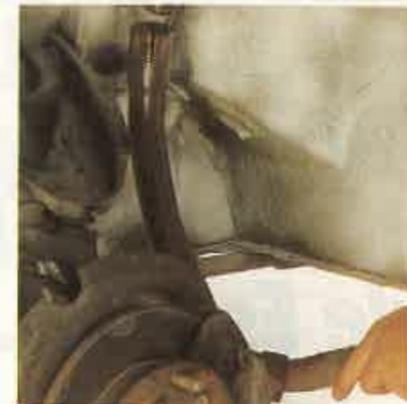
**7** Con el tubo ya suelto, sáquele totalmente. Sujete el tubo de escape con un alambre a alguna parte para que no rompan con su propio peso los tacos de goma que lo fijan a los bajos del coche.
