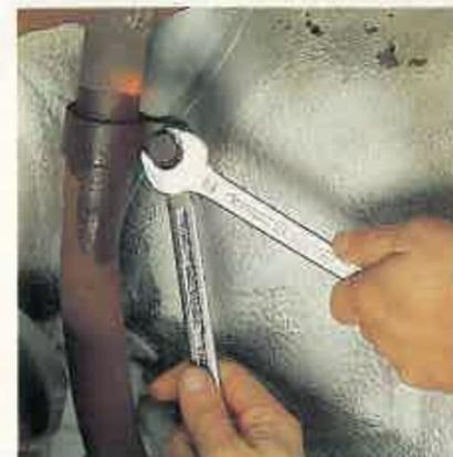
**4** Con dos llaves, afloje la abrazadera que une el silencioso al tubo de escape. Actúe con mucho cuidado, ya que la oxidación puede haber debilitado los tornillos y éstos se rompen al aflojarlos.
