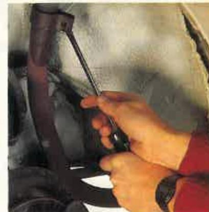
**5** Con un destornillador o una barra abra la abrazadera que oprime el tubo de escape contra el silencioso. Abrala hasta que ésta quede totalmente suelta y pueda moverse a lo largo del tubo.
