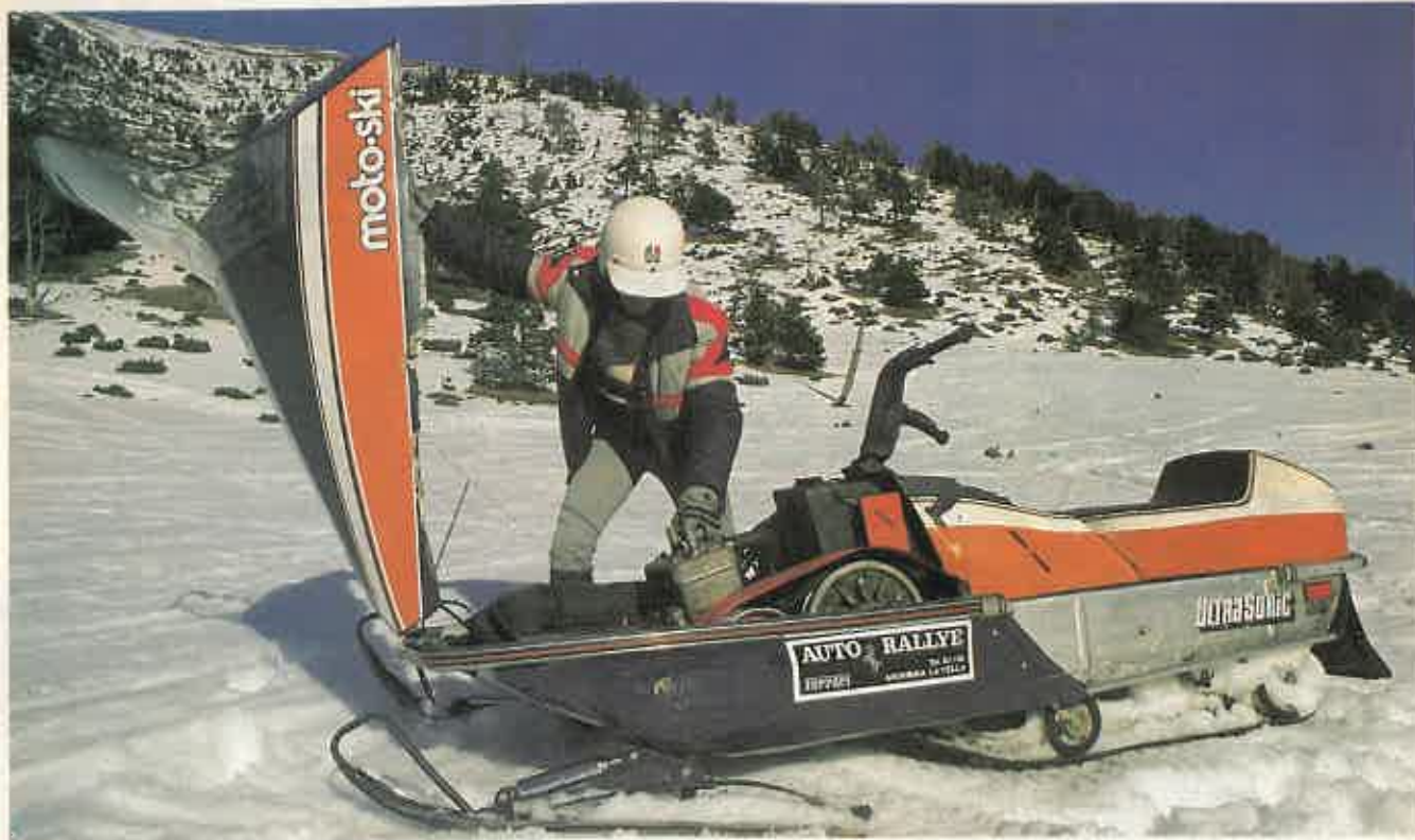
La accesibilidad mecánica es total El motor queda al descubierto cuando se levanta la parte superior de la carrocería
