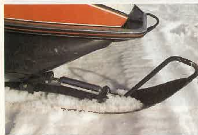
El amortiguador de doble efecto regula el funcionamiento del patín
