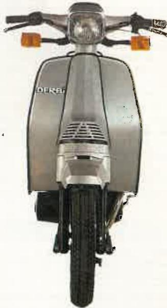
El arranque a pedal ha sido sustituido por un mando eléctrico que facilita la puesta en marcha. La dirección y el basculante están equipados con dos amortiguadores hidráulicos diseñados por Derbi. Este Scooter está bien equipado y su conducción es agradable y segura.
