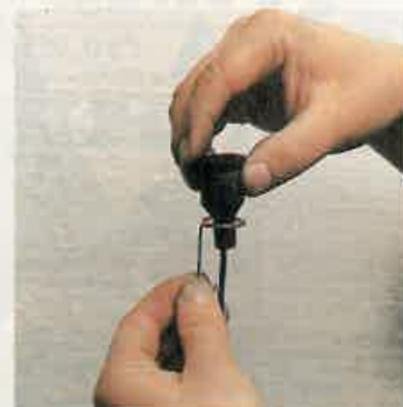
**10** Tome los sensores de ultrasonidos (un emisor y un receptor) y móntelo en su enganche. Por ningún motivo corte los cables de los sensores. Una pequeña variación en su longitud inutilizaría la alarma.
