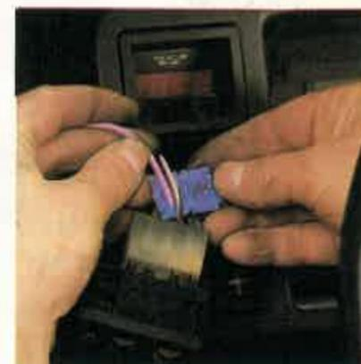
**8** Para hacer las tomas de corriente utilice las grapillas de presión que vienen en el kit de montaje. Para usarlas no hacen falta los cables, solamente tiene que disponerlos según se vayan a utilizar.
