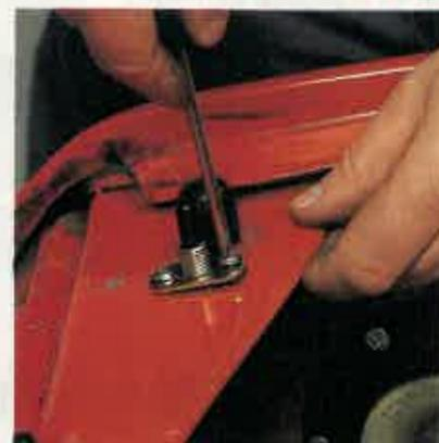
**4** Una vez que la altura del interruptor esté regulada fije éste en su sitio mediante los dos tornillos que tiene. Conecte la terminal del cable que va a alarma. Apunte el color del cable en un papel.
