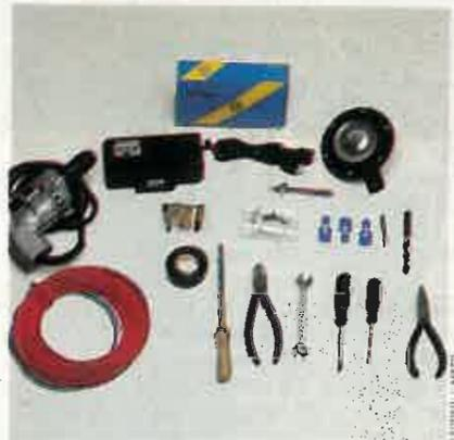
**1** El material es el mismo necesario que para cualquier intervención en el sistema eléctrico, más una taladradora para sujetar las piezas de la alarma en el vano del motor y en el interior del habitáculo.
