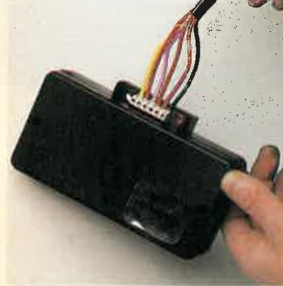
**12** Guiándose por el código de colores que haya usado, que no tiene que coincidir con el usado en este caso, conecte todos los cables en su terminal correspondiente, según indica el esquema eléctrico de la alarma.
