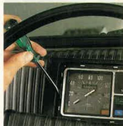
**5** El velocímetro suele estar sujeto por unas grapillas flexibles o por unos tornillos a los que se llega una vez que se han retirado los embellecedores y viseras antes de quitar el destornillador.
