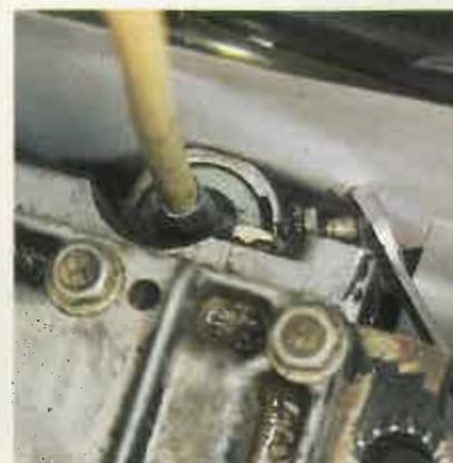
**3** Afloje el tornillo con la llave fija. Fíjese si este tornillo tiene una contratuerca; si es así, afloje ésta ligeramente antes de comenzar a aflojar el tornillo. Cuando esté flojo, tire del cable.
