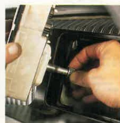
**14** Conecte el extremo superior del cable al velocímetro, asegurándose que el cuadradillo encaja perfectamente. Vuelva a conectar los terminales eléctricos y coloque de nuevo el velocímetro en su sitio.
