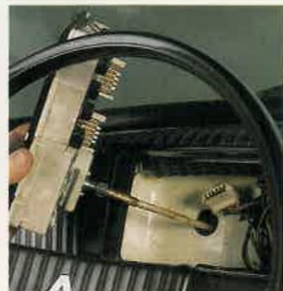
**7** Desconecte las terminales eléctricas del cuadro fijándose en qué punto encaja cada terminal. El cable del cuentakilómetros puede ir unido mediante tornillo o bien mediante algún tipo de pasador.
