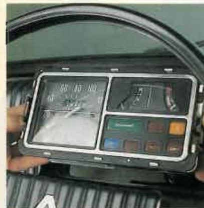
**6** Una vez que el cuadro está suelto, tire de él suavemente. Si nota alguna resistencia, vuelva al motor y revise que el cable no quedó enganchado en ninguna parte y empujelo hacia donde está el cuadro.
