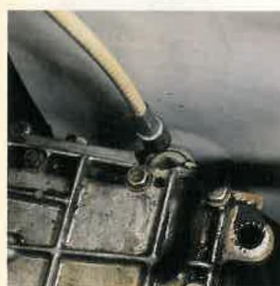
**12** Introduzca el extremo inferior del cable en su alojamiento en la caja de cambios. Apriete el tornillo hasta que tirando del cable éste no se mueva. Después apriete la contratuerca.
