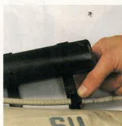
**13** Pase el cable por todos los sitios que hayan sido dispuestos para ello de forma que quede fijo, pero sin que tenga ninguna curva cerrada que lo pueda dañar. Este cable no debe quedar suelto dentro del motor.
