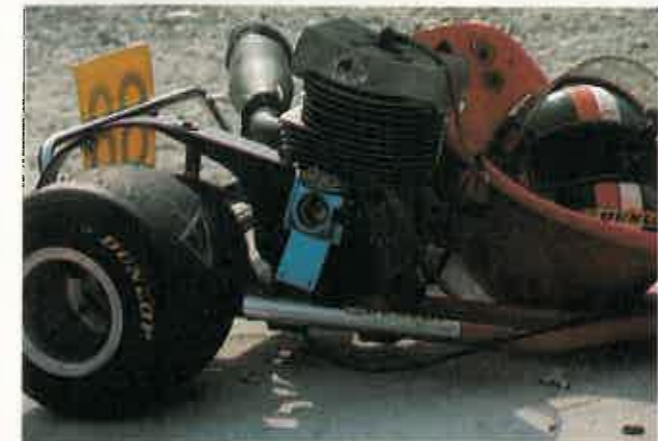
Un motor de competición, extremadamente potente pese a su sencillez y neumáticos sin dibujo de máxima adherencia
