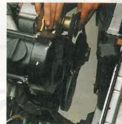
**8** Una vez que la correa está colocada en las poleas inferiores, introdúzcala en la polea del generador. Para facilitar su colocación, gire el generador con la mano mientras introduce la correa.
