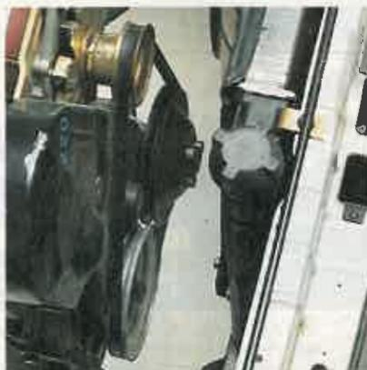
**2** En los motores longitudinales, la correa está en la parte delantera del motor, entre éste y el radiador. En coches más antiguos, la correa también moverá la polea del ventilador.
