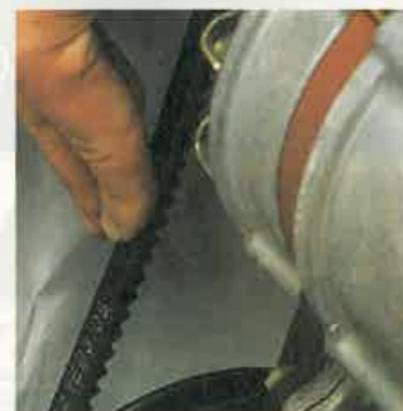
**10** Cuando estén todos los tornillos apretados, compruebe la tensión de la correa. Para ello presione con un dedo sobre la correa en el punto medio entre dos poleas. La holgura no debe de ser de más de un centímetro.
