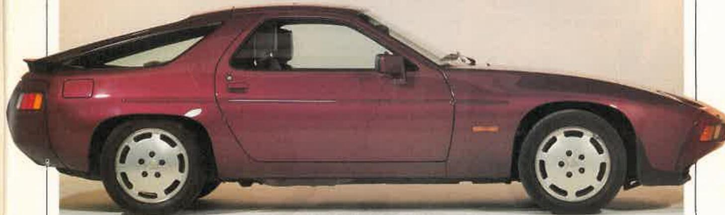
No hay paragolpes en el 928. La parte del morro y la trasera son deformables. Impresionante el motor de ocho cilindros en V y 300 caballos de potencia.
