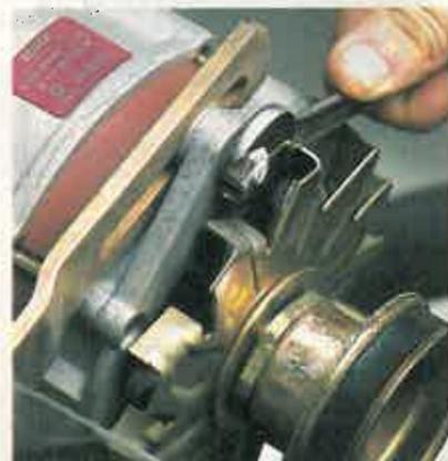
**3** Localice la tuerca que fija el generador. Esta tuerca está apretada sobre una pieza que permite el desplazamiento del generador para tensar posteriormente la correa. Normalmente la llave suele ser la número trece.
