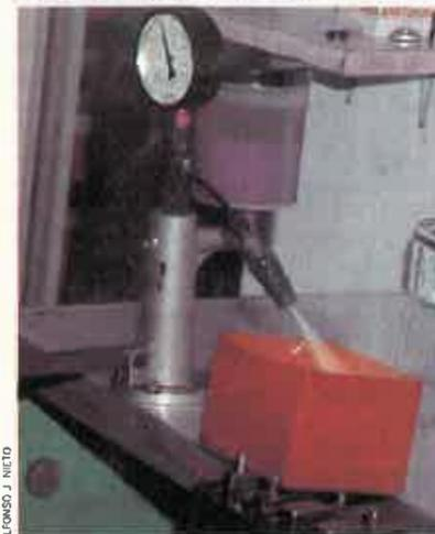
Comprobando los inyectores. No pulverizaban el gasóleo.
