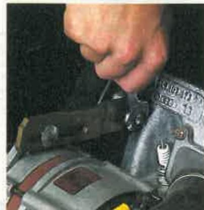
**4** Para facilitar el destensado de la correa y su sustitución, afloje la tuerca que aprieta el soporte del generador. En ninguno de los dos casos saque la tuerca, simplemente aflójela hasta que esté suelta.
