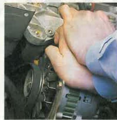
**13** Si el generador no baja por sí solo, presione sobre el mismo con las manos hasta que baje a una posición en la que se pueda sacar la correa usada, entonces coloque la nueva.
