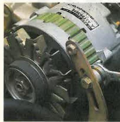
**12** El procedimiento es similar en estos motores que en los longitudinales. Primero afloje la tuerca del tensor, hasta que el generador se pueda desplazar a lo largo de la ranura.
