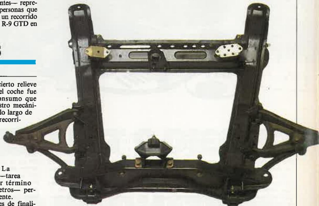
Sobre este chasis auxiliar descansa el motor. Dos de los cuatro tornillos estaban flojos.
