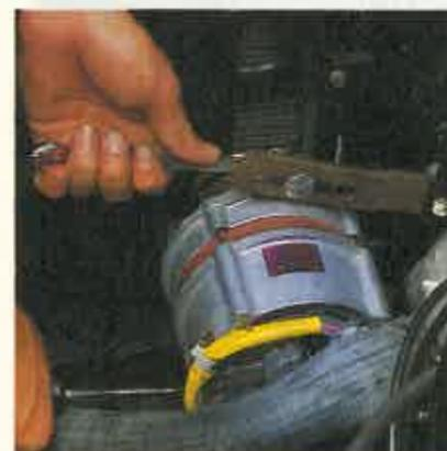
**9** Introduzca el destornillador en la parte inferior del generador, fijándose bien que la punta del destornillador no dañe nada. Apriete la tuerca del tensor a la vez que apalanca con el destornillador.
