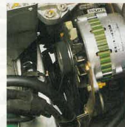
**11** En coches con motor transversal, la accesibilidad suele ser peor, ya que la correa está entre el motor y los abombamientos de los pasos de rueda, con lo cual el espacio para manipular es mínimo.
