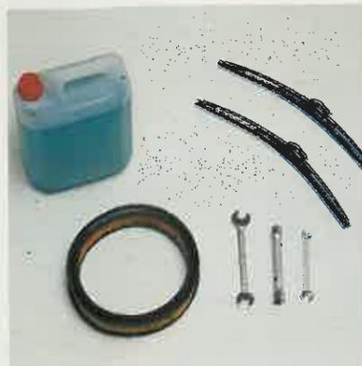
**1** En el supuesto que tenga que cambiar las escobillas y el filtro, aparte del anticongelante, sólo necesitará las llaves fijas necesarias para aflojar el tapón del radiador y la tapa del filtro.
