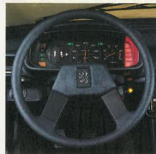
Testigo de precalentamiento, a la izquierda. En frío hay que esperar unos segundos para arrancar el GTD
