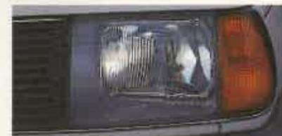
**Renault 18.** Marca: Cibie. Medidas: 17 cm. de alto, 21 cm. de ancho superior, 25 cm. de ancho inferior. Superficie: 374 cm<sup>2</sup>.
