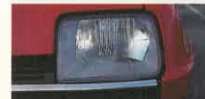
**Renault 5.** Marca: Cibie. Superficie: 15,5 cm. de alto, 20 cm. de ancho superior, 22,5 cm. de ancho inferior. Superficie: 310 cm<sup>2</sup>.
