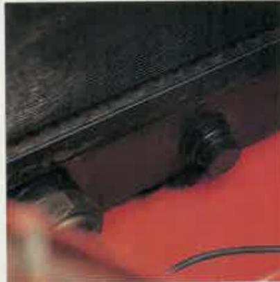
**2** En la parte baja del radiador, hacia la parte del motor, encontrará el tapón de vaciado del radiador. Algunos coches, en vez de llevar una tuerca, llevan una palomilla que se puede aflojar con la mano.
