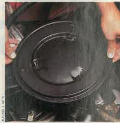
**10** Fíjese en la posición que está la tapa y el punto de referencia para que, al volver a colocarla, quede ajustada en su posición correcta. De esta sencilla operación depende en parte el buen funcionamiento del motor.
