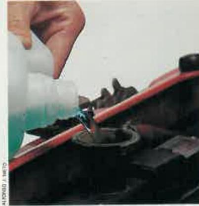
**5** Ponga el tapón de vaciado del radiador y apriételo. A continuación llene el radiador con el nuevo anticongelante, siempre con el purgador de la calefacción abierto, hasta que no entre más.
