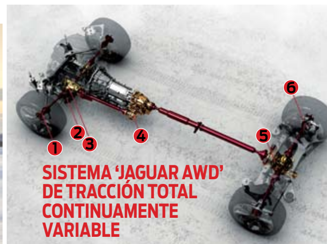
◀ 1.- Sensor de la presión de frenada. 2.- Sensor del ángulo de la dirección. 3.- Diferencial delantero. 4.- Caja de transferencia con TCCM. 5.- Diferencial trasero. 6.- Sensor de velocidad del coche (uno por rueda). Jaguar AWD prioriza el par en el tren trasero, pero el sistema consta de un embrague multidisco con acoplamiento viscoso que dirige par al tren delantero, mediante un árbol de transmisión articulado, según lo dictado por la caja TCCM.
