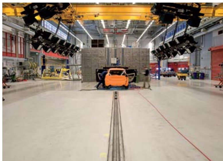
▲▲ Los impactos se producen sobre un foso con cubierta transparente equipado para filmar con precisión todo lo que ocurre en el momento del golpe bajo el coche y también hay cámaras de alta definición a 11 metros de altura para grabar la parte superior.
