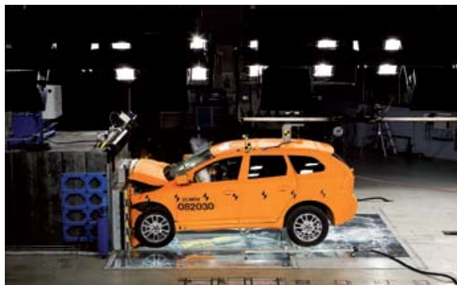
▲▲ Los impactos se producen sobre un foso con cubierta transparente equipado para filmar con precisión todo lo que ocurre en el momento del golpe bajo el coche y también hay cámaras de alta definición a 11 metros de altura para grabar la parte superior.
