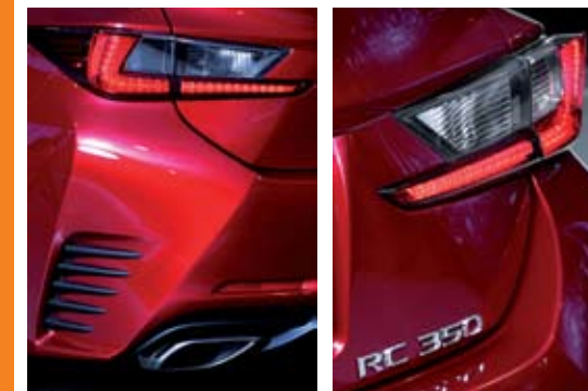
▲ Faros Led tanto delante como detrás y discretos apéndice para mejorar la aerodinámica.
