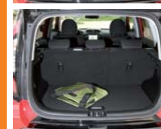
El maletero ha crecido hasta los 354 litros, pero cuenta con una tapa bajo la que hay un organizador de carga. Esta tapa le resta volumen. Los respaldos traseros se abaten para aumentar la capacidad de carga.
