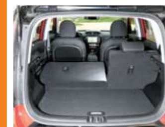
El maletero ha crecido hasta los 354 litros, pero cuenta con una tapa bajo la que hay un organizador de carga. Esta tapa le resta volumen. Los respaldos traseros se abaten para aumentar la capacidad de carga.
