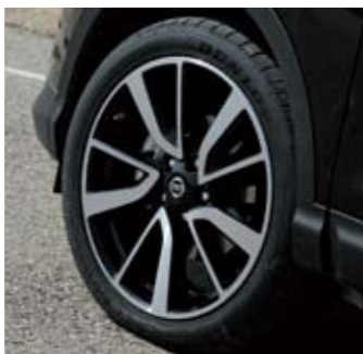
▲ Equipa neumáticos 215/60 R17, pero por 500 euros se pueden pedir éstos 225/40 R19. La tracción total AllMode 4x4i es efectiva y hay 18,5 centímetros de altura libre al suelo.
