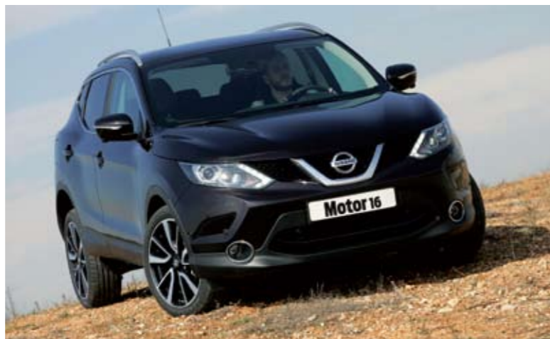
▲ Equipa neumáticos 215/60 R17, pero por 500 euros se pueden pedir éstos 225/40 R19. La tracción total AllMode 4x4i es efectiva y hay 18,5 centímetros de altura libre al suelo.
