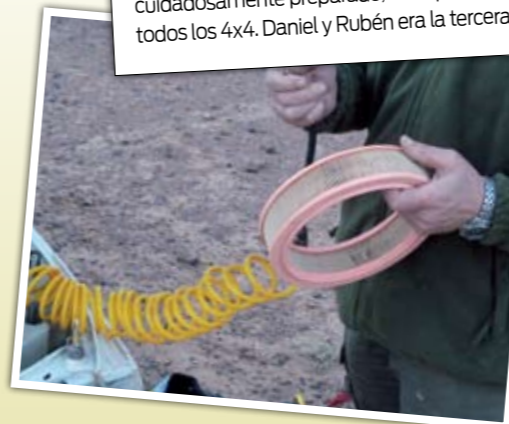
◀ El ritual diario al llegar al campamento era desmontar el filtro de aire y soplarlo con el compresor para sacarle el polvo y la arena que había chupado durante kilómetros y kilómetros de caminos. Arena para hacer unos cuantos castillos.
