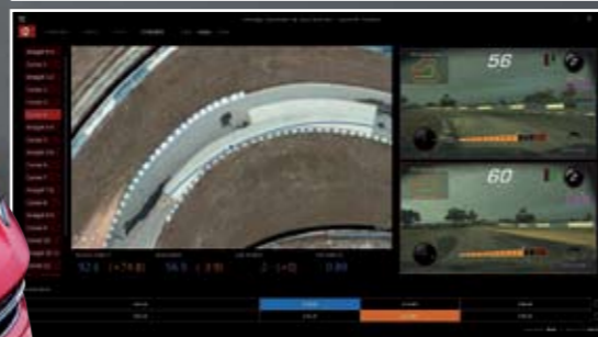
▶ El PDR (Performance Data Recorder) graba el vídeo según el modo elegido: desde el Touring, sólo con imagen y sonido, hasta el Track, que añade el máximo de datos.
