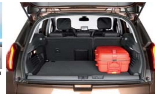
◀◀ El portón trasero se abre en dos partes. El interior es amplio y el piso en la zona de atrás es plano. Destacar, por su capacidad, el enorme cofre central.
