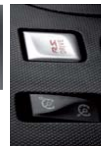
▲ El R.S. Drive permite elegir los modos Normal y Sport para el cambio, la dirección o el motor.
