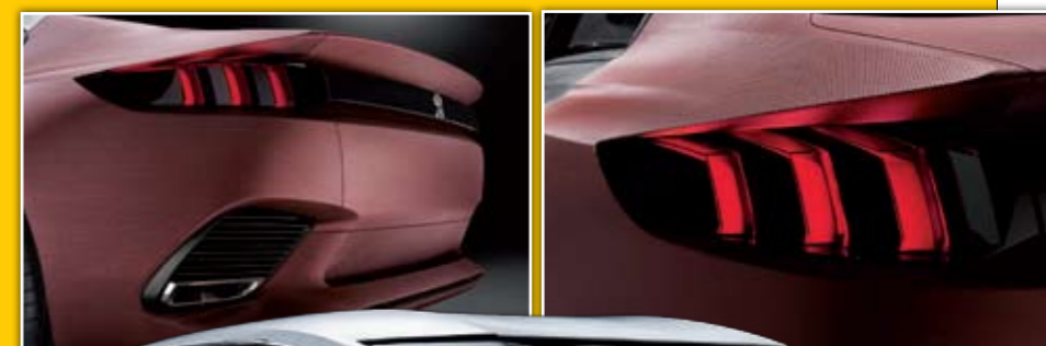
▲▼ En la carrocería, de 4,70 metros de longitud y sólo 1,31 de altura, destaca la alta línea de cintura, el parabrisas muy inclinado y el largo capó. Pero, sobre todo, el tejido rojo Shark Skin que recubre la parte trasera, y que rebaja el índice aerodinámico junto al extractor del paragolpes trasero, la curvatura del techo y la forma de los retrovisores. Las llantas son de 20 pulgadas.
