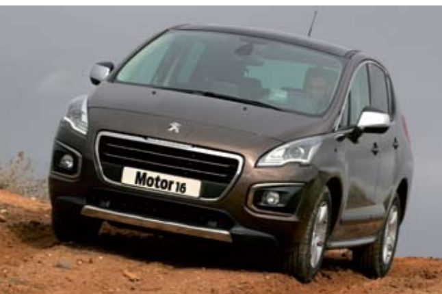
◀ El Grip Control es un control de tracción inteligente que se ofrece en opción. Contempla cinco modos de uso y obliga a montar llantas de 16 pulgadas y neumáticos de uso mixto. Es una solución eficaz.
